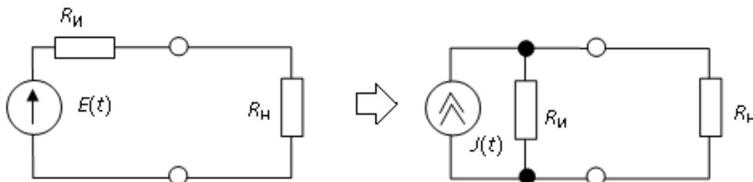
Преобразуйте неидеальный источник напряжения  $E(t)=10$  В,  $R_n = 50$  Ом,  $R_i = 1$  кОм в эквивалентный ему источник тока  $J(t)$ . Величину источника тока указать в мА. Ответ при необходимости округлить до целого числа.
