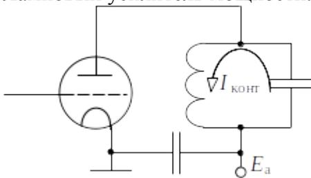
Дано: характеристическое сопротивление контура  $\rho = 100 \text{ Ом}$ , резонансное сопротивление  $R_{рез} = 2 \text{ кОм}$ , амплитуда первой гармоники анодного тока  $I_{a1} = 1 \text{ А}$ . Амплитуда контурного тока будет равна:
