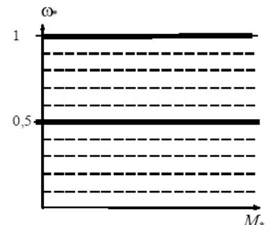
Какому способу регулирования соответствует искусственная механическая характеристика двигателя постоянного тока, изображенная на рисунке?
