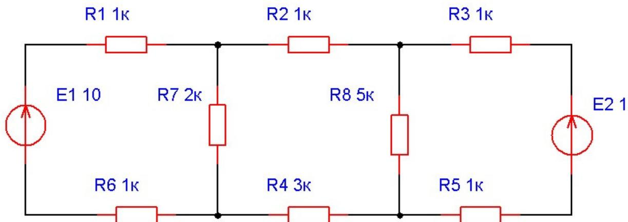
2. Реализовать математическую модель электрической цепи в среде MathCad. Для схемы согласно заданному варианту: получить структурную матрицу, с использованием структурной матрицы записать в среде MathCad уравнения по первому и второму законам Кирхгофа и закону Ома в матричной форме, решить систему уравнений с помощью возможностей MathCad, вывести значения напряжений на всех ветвях схемы.
