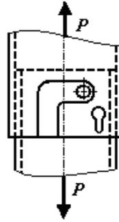
4. Определить допускаемое усилие для клеевой конструкции  $[\tau_{ср}] = 10$  МПа,  $a = 30$  мм,  $b = 20$  мм.
