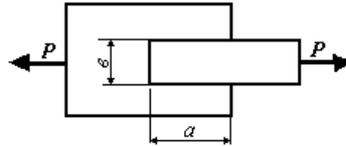
5. Проверить прочность шпоночного соединения зубчатого колеса с валом (рис. 71), если вращающий момент на валу  $T = 10$  Н·м, диаметр вала  $d = 20$  мм,  $[\tau_{ср}] = 100$  МПа,  $[\sigma_{см}] = 200$  МПа, размеры шпонки:  $5 \times 5 \times 10$ .
