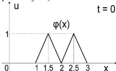
5. Однородная струна длиной  $l$  жестко закреплена на концах  $x=0$  и  $x=l$ . Струну отклонили от положения равновесия и в момент времени  $t=0$  отпустили без начальной скорости. Требуется определить отклонения  $u(x, t)$  струны в любой момент времени, если ее
