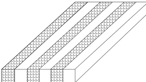
Они определяются очевидным образом  $\sigma_1 = \sigma_2 = \sigma = P/a^2$ . Деформации определяются как  $\varepsilon_1 = \sigma/E_1$ ,  $\varepsilon_2 = \sigma/E_2$ .
