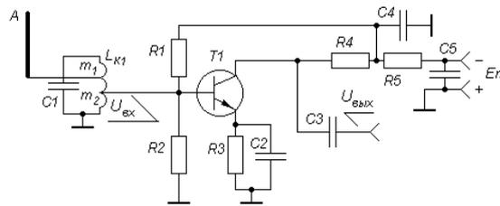
3. Найдите и исправьте две ошибки в схеме линейного последовательного амплитудного детектора (АД). Определите частоту модуляции источника ЭДС ( $E$ ), при которой искажения из-за инерционности нагрузки детектора ( $R1, C3$ ) и из-за разделительной цепи ( $C4, R2$ ) возникают при одном и том же коэффициенте модуляции сигнала, если:  $R1 = 10 \text{ кОм}$ ;  $R2 = 40 \text{ кОм}$ ;  $C3 = 500 \text{ нФ}$ .
