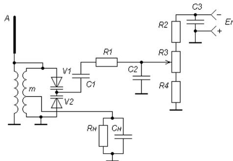
2. Найдите и исправьте две ошибки в схеме преселектора. Определите полосу пропускания преселектора по уровню  $d = 0,7$ , если: частота настройки входной цепи (ВЦ)  $f_o = 80 \text{ МГц}$ ; избирательность по зеркальному каналу  $\sigma_3 = 20 \text{ дБ}$ ; промежуточная частота супергетеродина  $f_{np} = 10 \text{ МГц}$ ;  $f_z > f_o$ .
