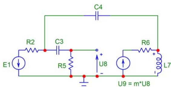
Записать систему уравнений в матричной форме  $\mathbf{T} \cdot \mathbf{X} = \mathbf{W}$  модифицированным узловым методом для указанной ниже схемы.
