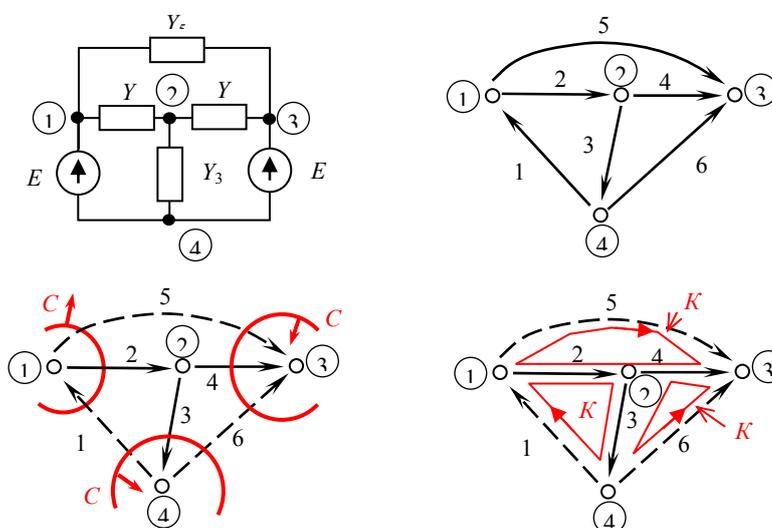
На рисунке показана электрическая схема цепи и ее направленный граф, на котором выделены главные сечения и контура. Нужно записать матрицу главных сечений (контуров) схемы.
