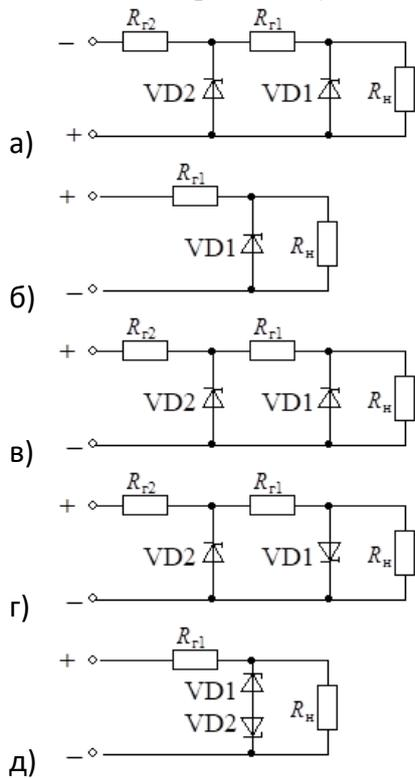
5. Чему равен коэффициент полезного действия стабилизатора, приведенного на рисунке, если:
