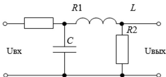
$$R_1 = 100 \text{ Ом}, R_2 = 300 \text{ Ом}, C = 5 \cdot 10^{-6} \text{ Ф}, L = 0,5 \text{ Гн}$$
