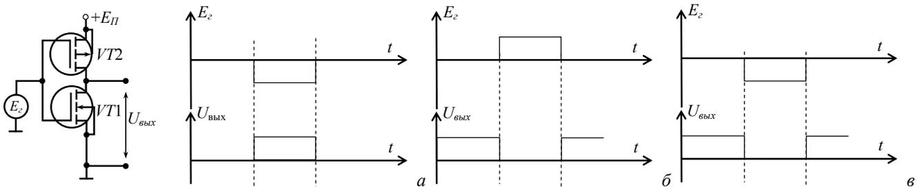
9. Выбрать схему, выполняющую логическую функцию «ИЛИ», на биполярных транзисторах *pnp*:
