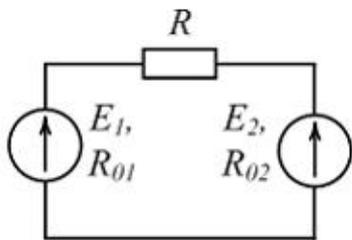
1. E1- в режиме активного приемника; E2- в режиме генератора.
