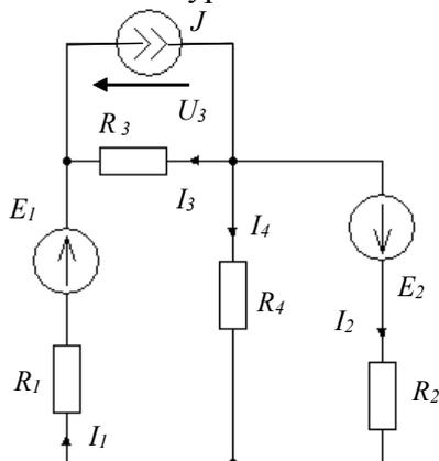
1.  $-E_1 I_1 - E_2 I_2 + J U_3 = R_1 I_1^2 + R_2 I_2^2 + R_3 I_3^2 + R_4 I_4^2$
