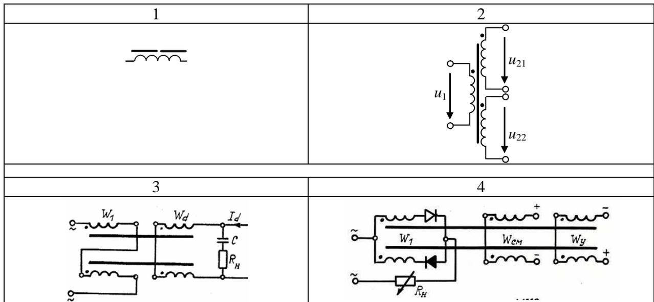
16. На каком рисунке представлено условное графическое обозначение нерегулируемого магнитного усилителя?
