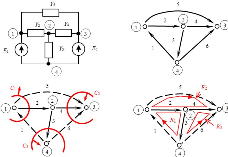
На рисунке показана электрическая схема цепи и ее направленный граф, на котором выделены главные сечения и контура. Записать матрицу главных сечений схемы.
