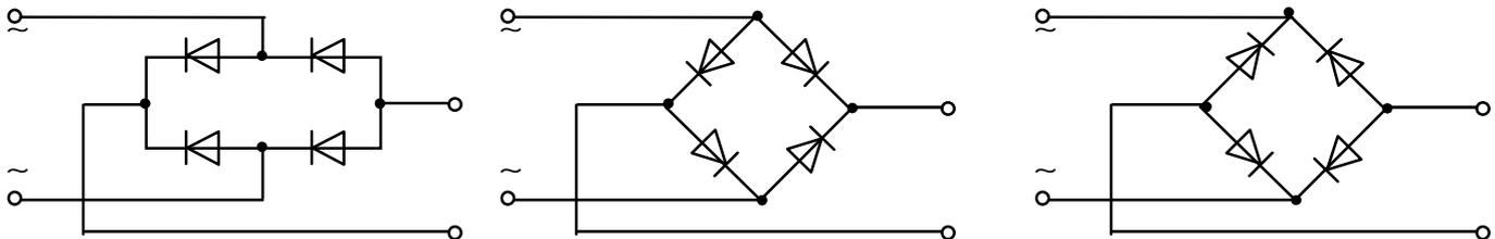
16. Какая из схем является трехфазной мостовой схемой выпрямления?
