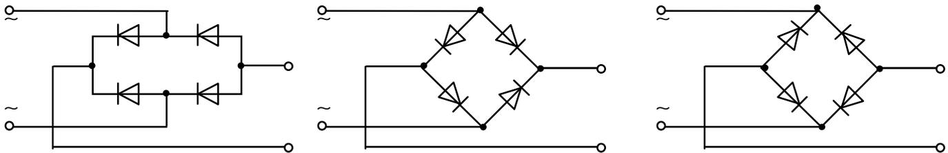
16. Какая из схем является трехфазной мостовой схемой выпрямления?
