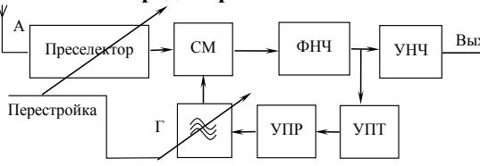
Приёмник с прямым преобразованием частоты асинхронного типа
