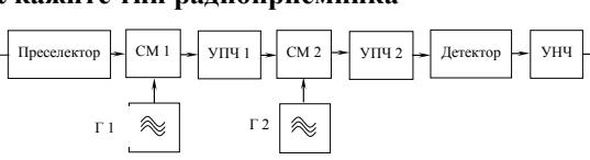
Супергетеродинный приёмник с асинхронным детектором
