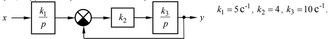
**Задание 2.** По заданной передаточной функции разомкнутой цепи  $W(p)$  построить ее асимптотическую ЛАЧХ:
