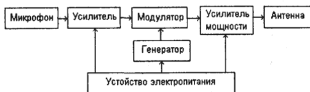
Рис. 5.18. Схема акустической закладки
