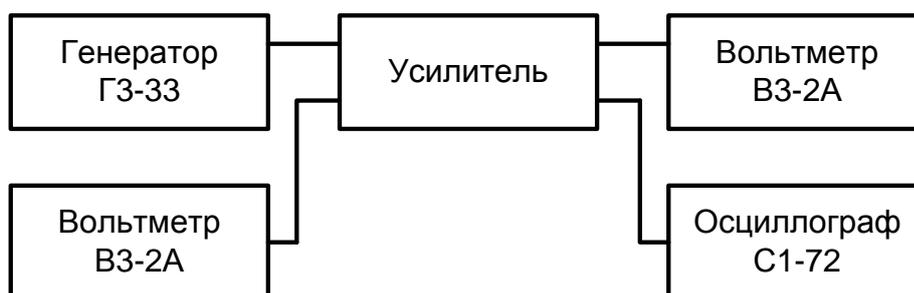
Рис. 3.4. Структурная схема экспериментальной установки.
