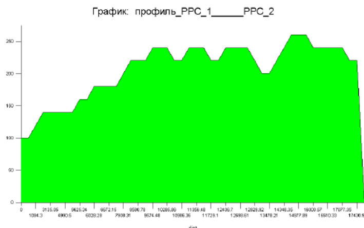
Рисунок 1.7 - График профиля рельефа местности, полученный при помощи утилиты Iso2prof
