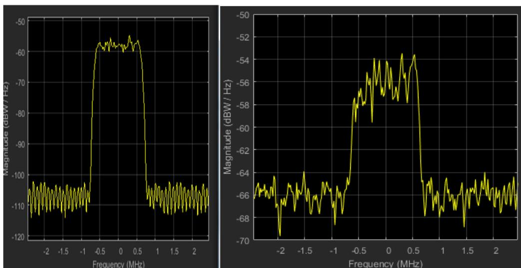
Рис. 14 – Спектр исходного сигнала и сигнала на выходе канала при SNR=5 дБ с доплеровским смещением частоты  $f_d = 600$  Гц
