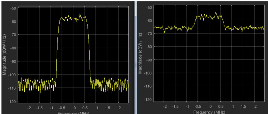
Рис. 11 – Спектр исходного сигнала и сигнала на выходе канала при SNR=5 дБ
