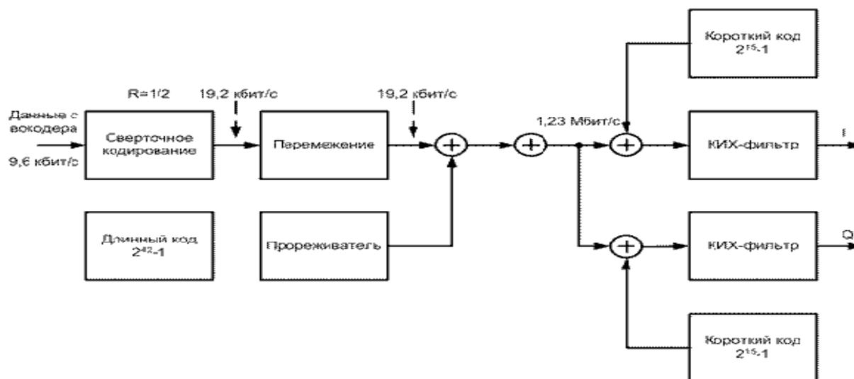
Рис. 1 - Схема кодирования в прямом канале
