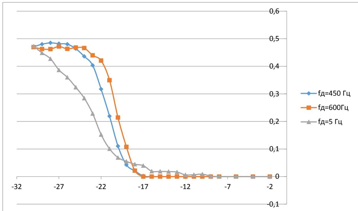
Рис. 17 - Зависимость вероятности битовой ошибки BER от SNR в канале с многолучевым распространением при разных смещениях доплеровских частот
