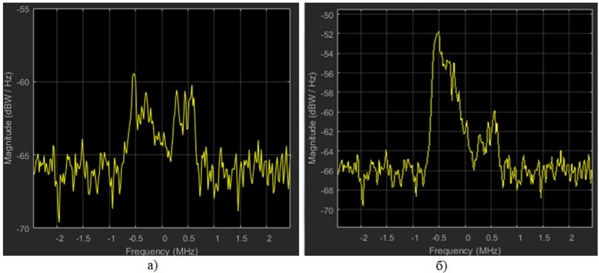
Рис. 15 – Спектр сигнала на выходе канала при SNR=5 дБ с доплеровским смещением частоты  $f_{\delta} = 450 \text{ Гц}$  (а) и  $f_{\delta} = 5 \text{ Гц}$  (б)
