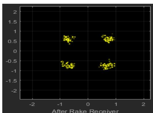
Рис. 10 - Сигнал, декодированный мобильной станцией, на I-Q диаграмме при отсутствии канала распространения
