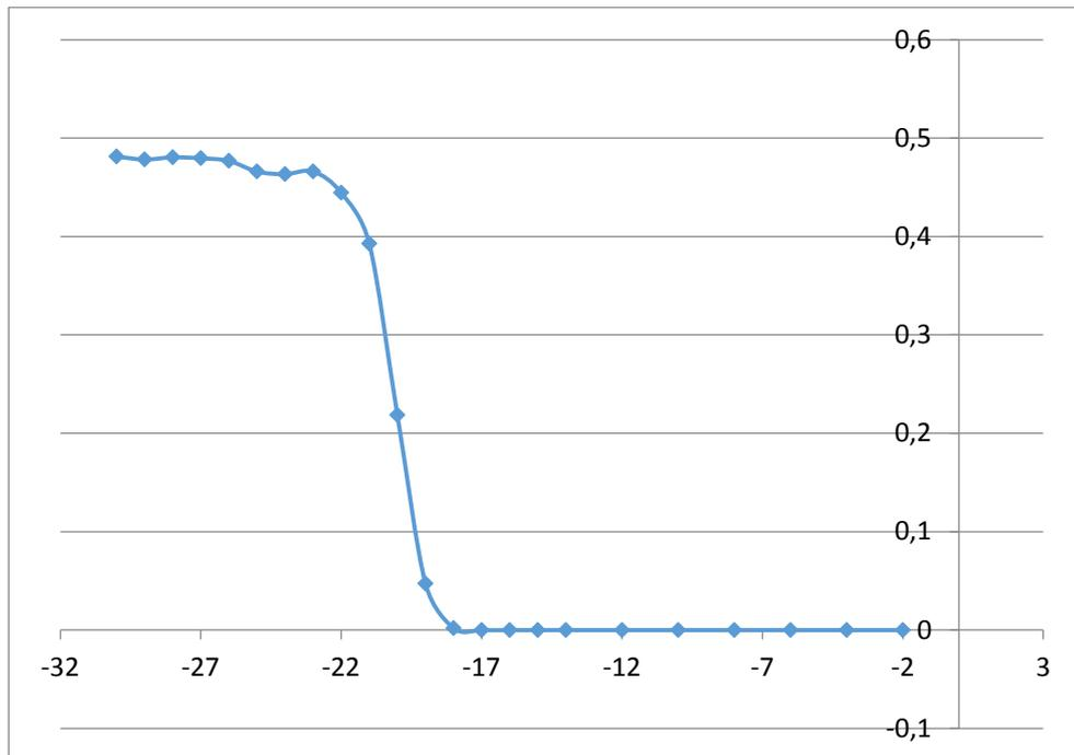
Рис. 13 - Зависимость вероятности битовой ошибки BER от отношения сигнал/шум SNR в канале с шумами без многолучевого распространения
