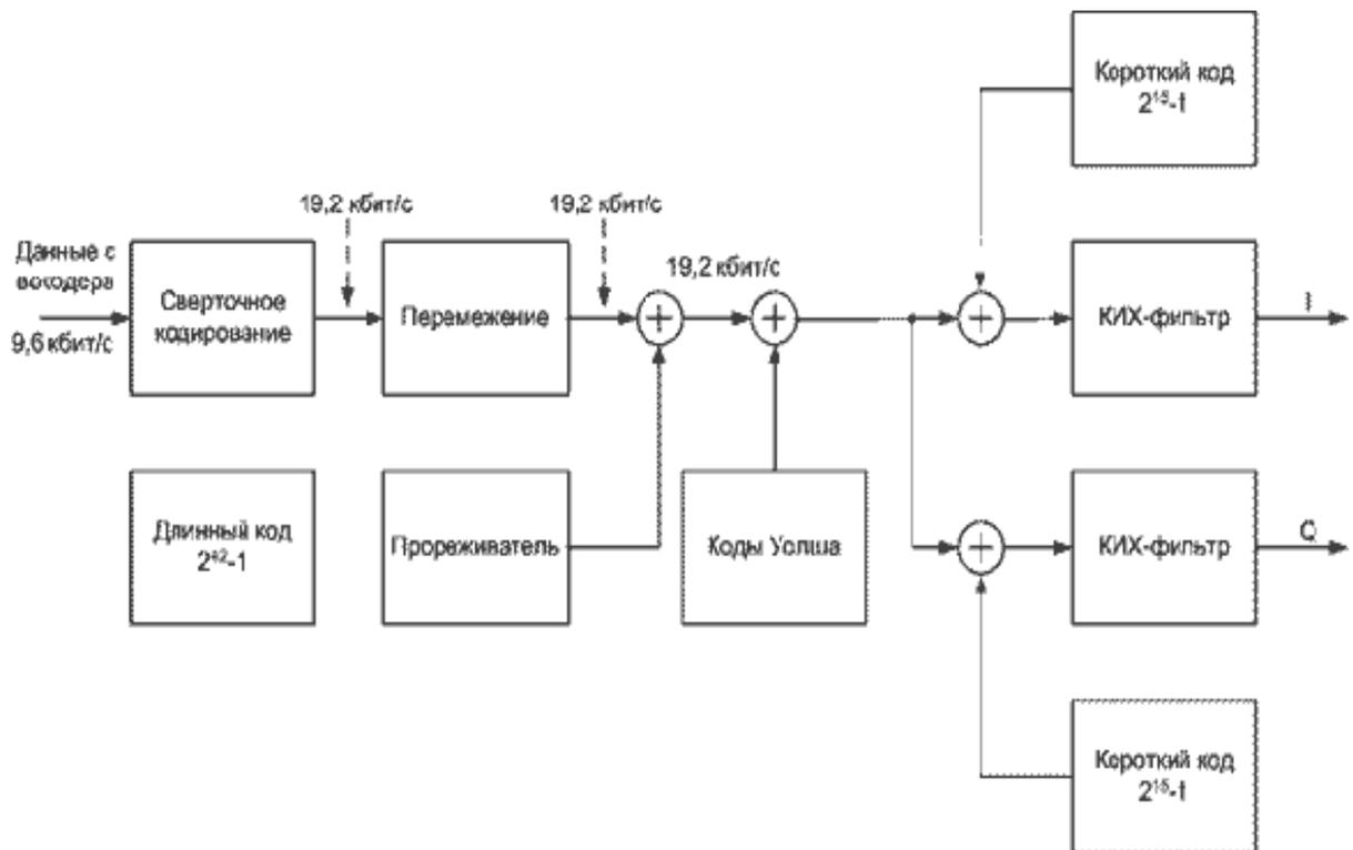
Рис. 2 - Схема кодирования в обратном канале
