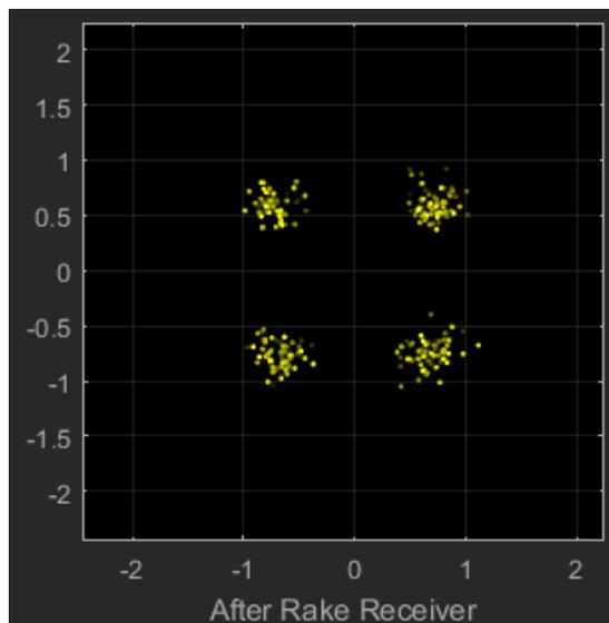
Рис. 12 - Сигнал, декодированный мобильной станцией, на I-Q диаграмме
