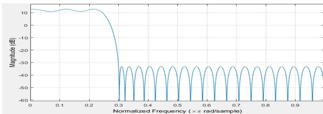
Рис. 7 - АЧХ фильтра приемника
