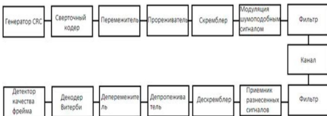
Рис. 3 - Структурная схема CDMA
