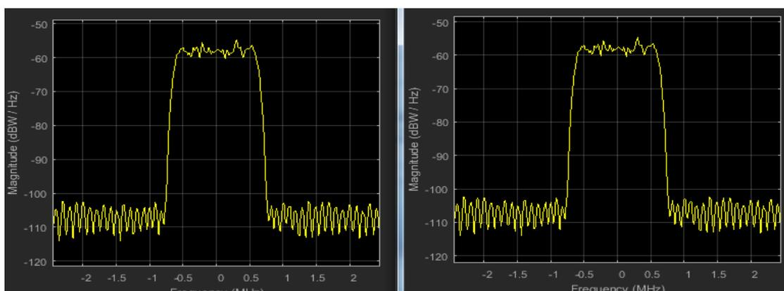
Рис. 9 – Спектр сигналов на выходе передатчика и на входе приемника при отсутствии канала распространения
