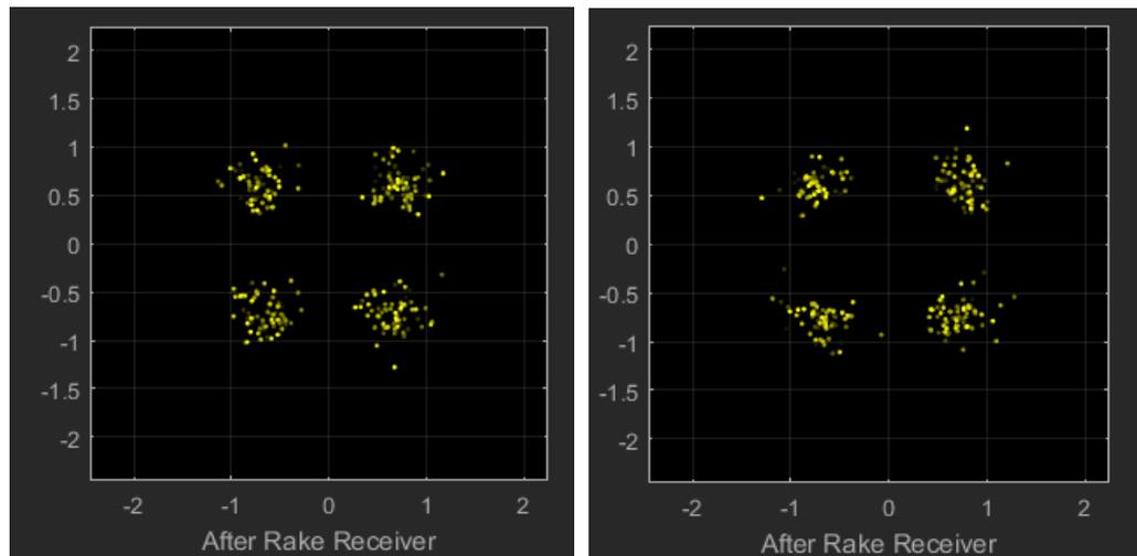
Рис. 16 - Сигнал, декодированный мобильной станцией, на I-Q диаграмме при  $f_{\delta} = 5 \text{ Гц}$  и  $f_{\delta} = 600 \text{ Гц}$
