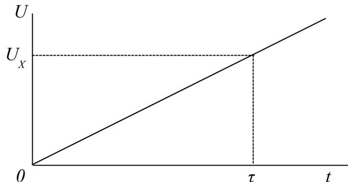
Рисунок 2.1 — преобразование напряжения в отрезок времени
