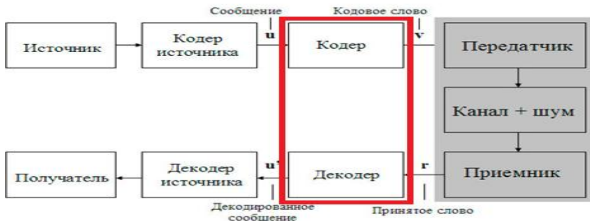
Рис. 3.1. Структурная схема системы передачи дискретной информации
