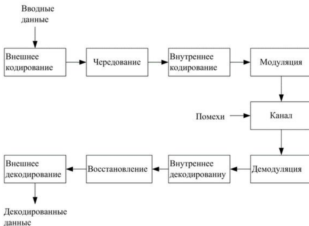
Рис. 3.139. Обобщенная структурная схема исследования каскадных кодов
