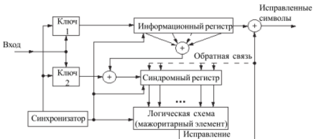
Рис. 3.70. Общая схема декодера для сверточного кода
