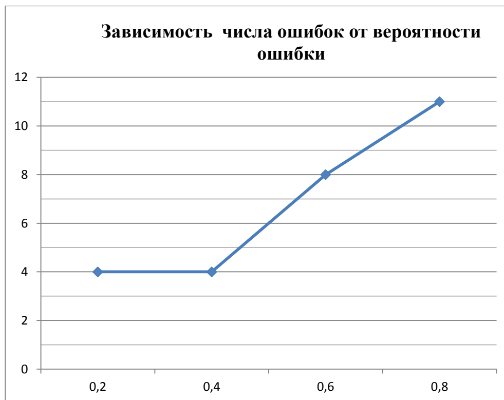
Рис. 3.23. График зависимости числа ошибок (OY) от вероятности ошибки (OX) для кода Хэмминга (15,11)
