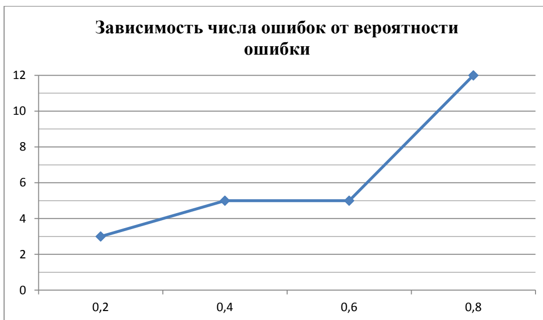
Рис. 3.18. График зависимости числа ошибок (OY) от вероятности ошибки (OX) для кода Хэмминга (7,4)
