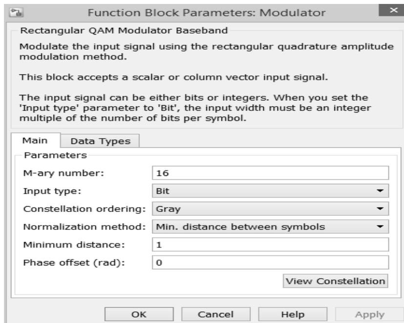
Рис. 232. Параметры 16-QAM модулятора
