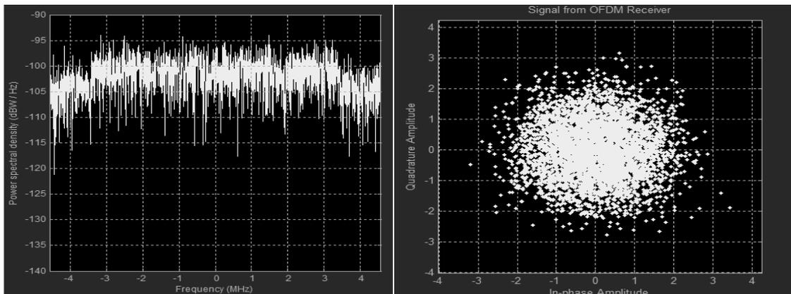
Рис. 208. Спектр OFDM-сигнала и диаграмма созвездий 64-QAM при SNR=1 дБ
