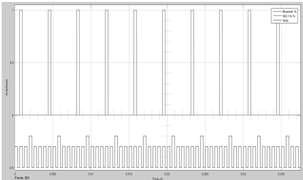
Рис. 87. Временная диаграмма Bluetooth без мешающего сигнала 802.11
