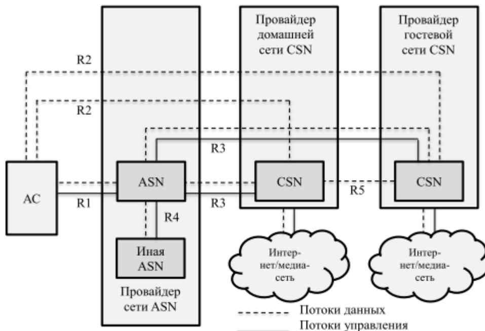
Рис. 97. Базовая модель WiMAX-сети
