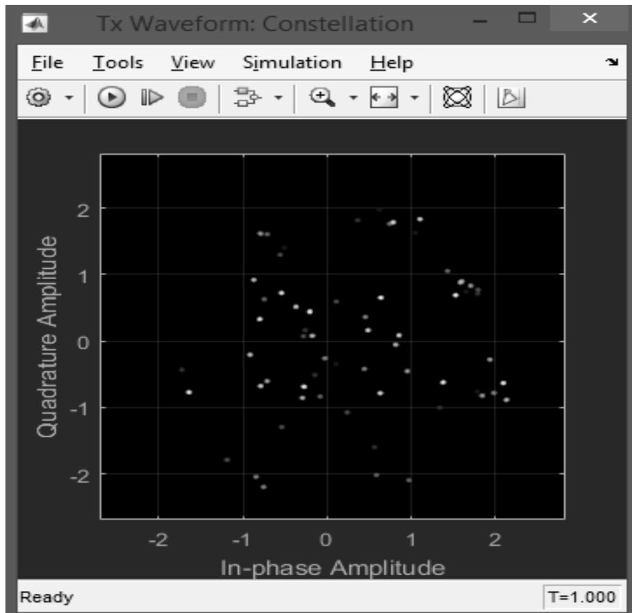
Рис. 31. Сгенерированный базовой станцией сигнал на I-Q диаграмме.
