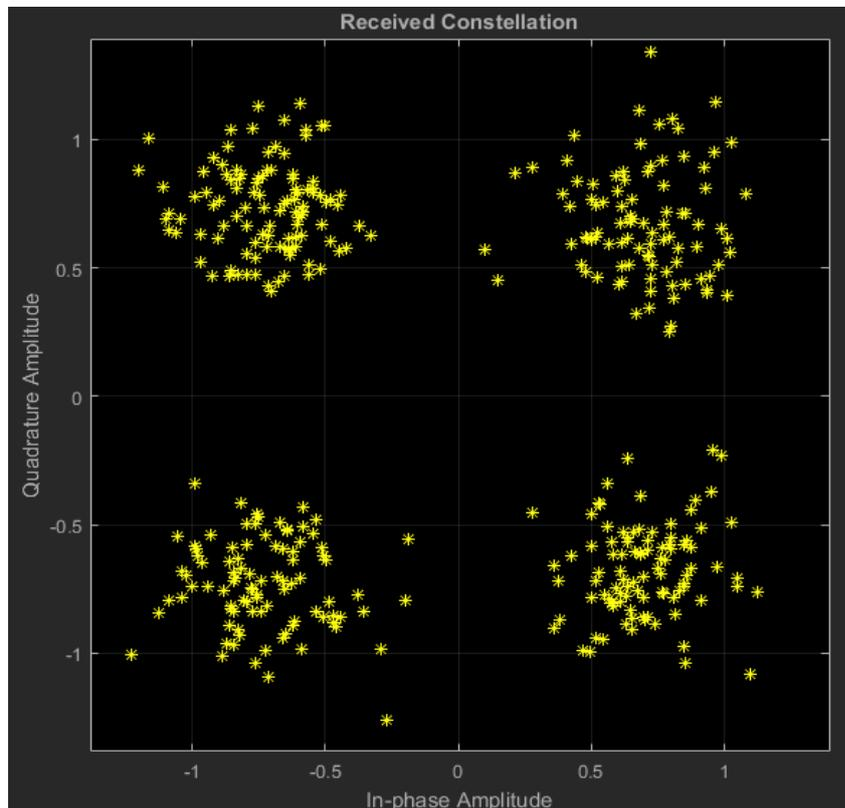
Рис. 145 – Созвездие принимаемого сигнала (SNR = 11)
