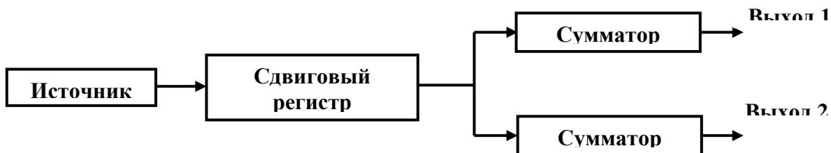
Рис. 188. Структурная схема сверточного кодера
