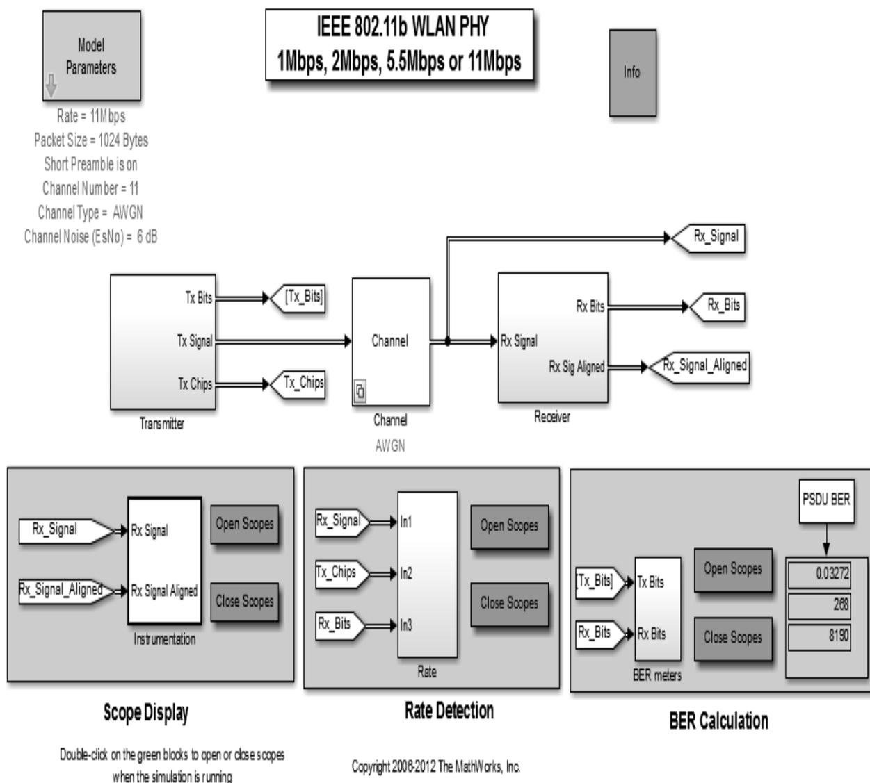
Рис. 58. Модель радиointерфейса 802.11b Simulink MATLAB 2015b
