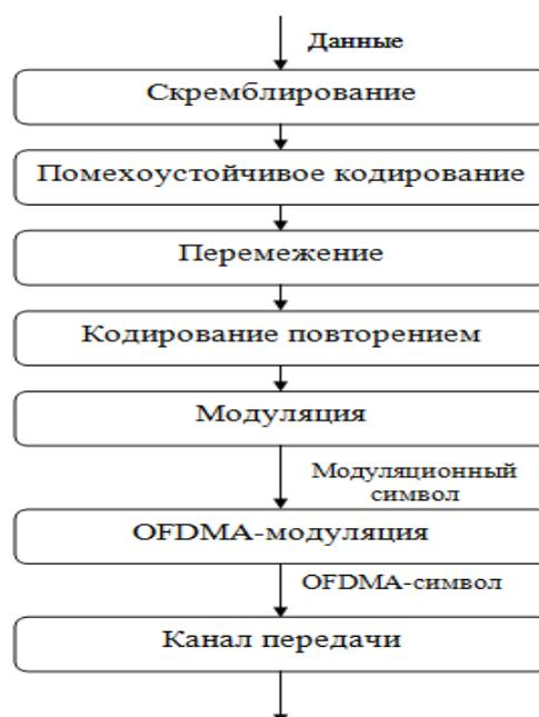
Рис. 102 – Преобразования данных на физическом уровне WiMAX
