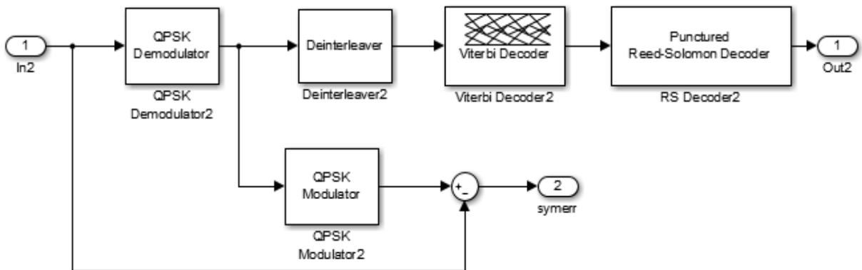
Рис. 127 – Состав блока демодулятора «QPSK 3/4»
