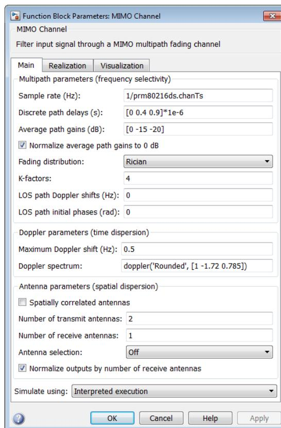
Рис. 140 – Параметры системы, изменяемые в блоке «MIMO Channel»
