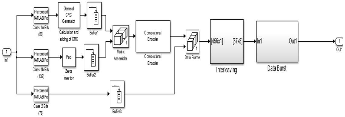
Рис. 4. Схема кодера
