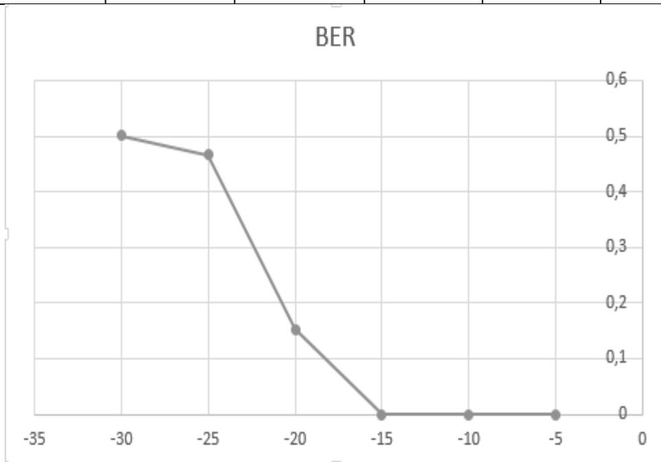
Рис. 44. Зависимость BER от SNR в канале с многолучевым распространением
