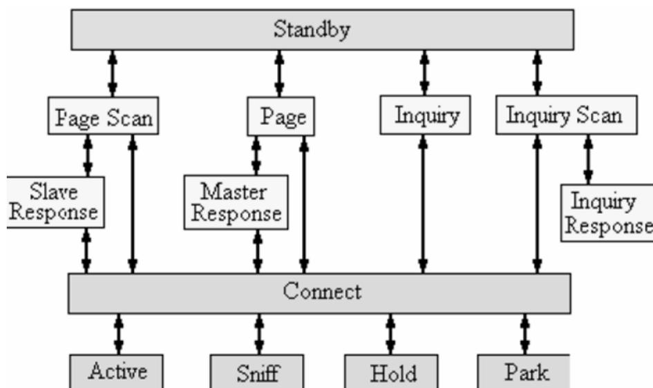
Рис. 84. Состояние соединений
