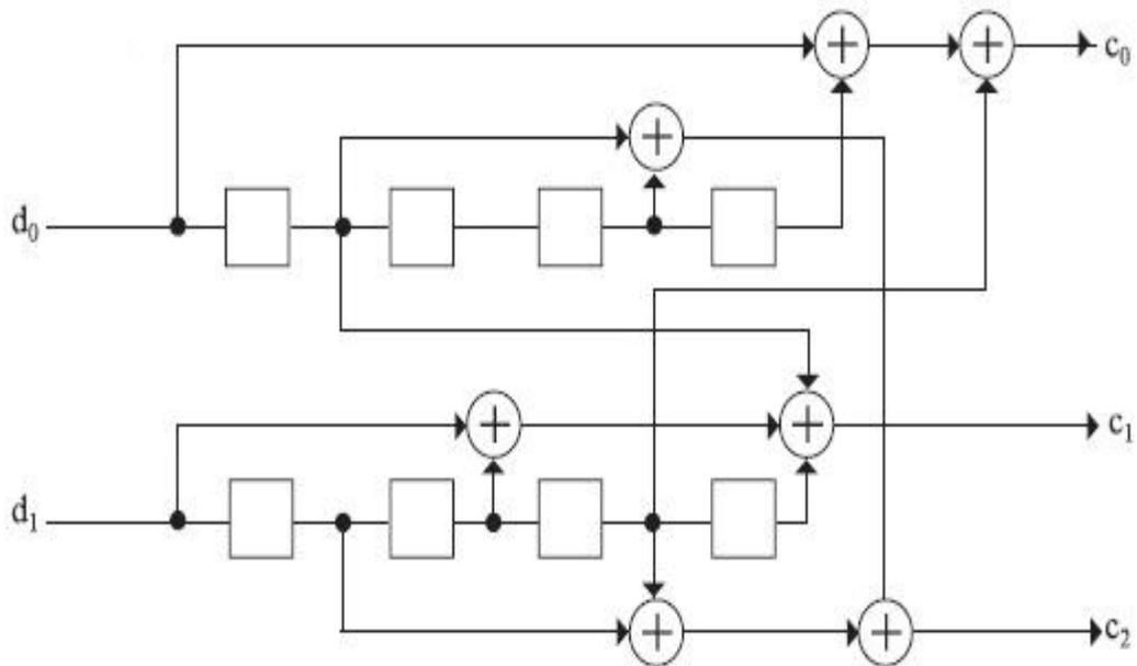
Рис. 53. Сверточное кодирование с тремя битами кодовой последовательности
