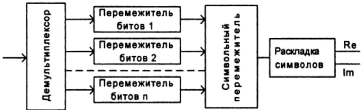
Рис. 201. Структурная схема внутреннего перемежителя системы DVB-T
