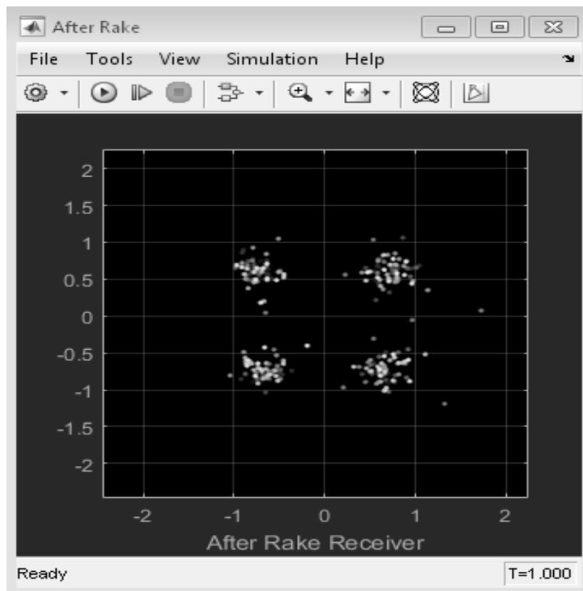
Рис. 29. Сигнал, декодированный мобильной станцией, на I-Q диаграмме.
