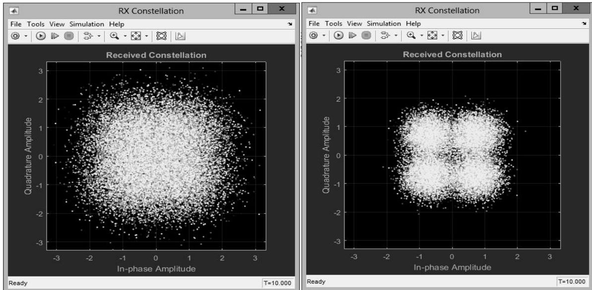
Рис. 205. Созвездие при  $E_b/N_0 = 0,5$  и  $E_b/N_0 = 5$
