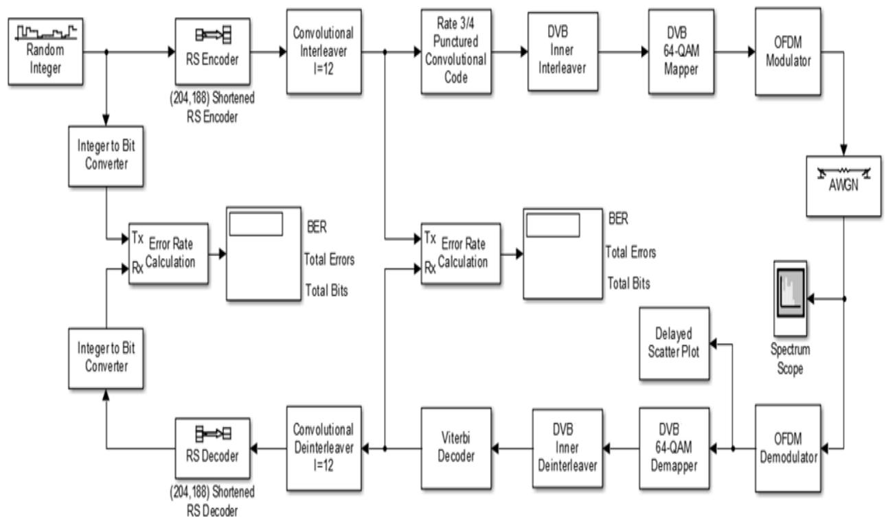
Рис. 225. Структурная схема DVB-H в режиме 2k Mode
