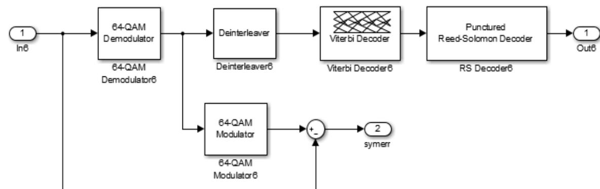
Рис. 131 – Состав блока демодулятора «64QAM 3/4»
