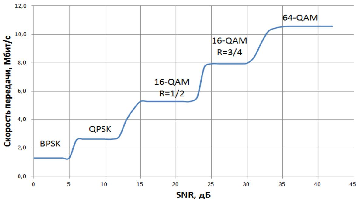
Рис. 151 – График зависимости скорости передачи от SNR
