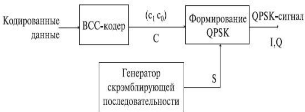
Рис. 51. Общая схема PBCC-модуляции
