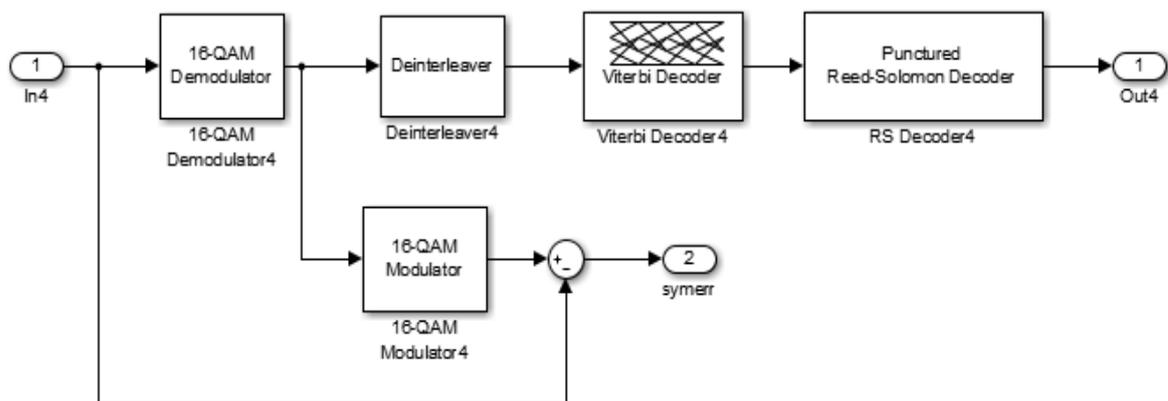
Рис. 129 – Состав блока демодулятора «16QAM 3/4»
