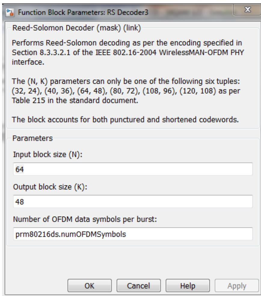
Рис. 136 – Состав блока декодера Рида-Соломона «RS Decoder 16QAM 1/2»
