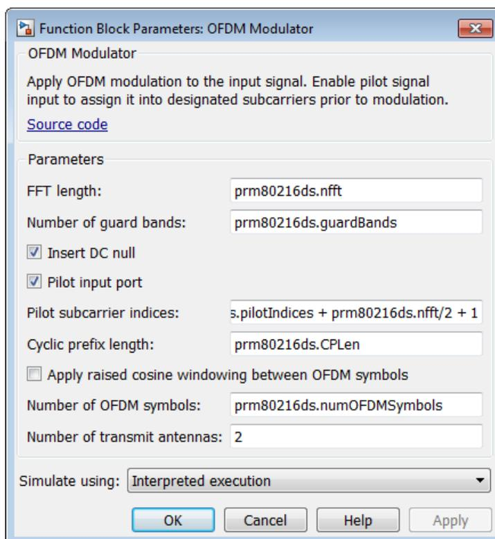
Рис. 137 – Параметры системы, изменяемые в блоке «OFDM Modulator»
