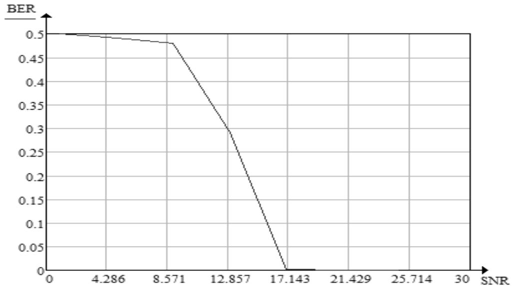
Рис. 207. Зависимость BER от SNR для системы DVB-T при использовании 64-QAM
