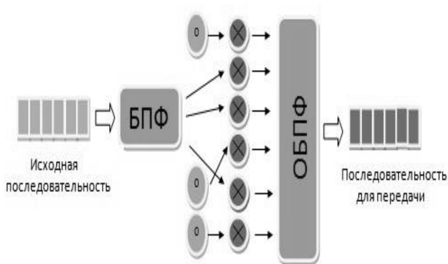
Рис. 159. SC-FDMA – модулятор
