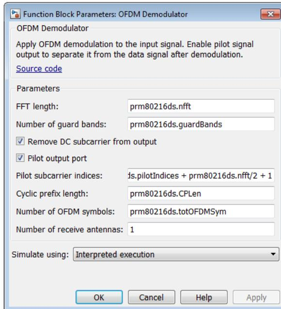
Рис. 139 – Параметры системы, изменяемые в блоке «OFDM Demodulator»
