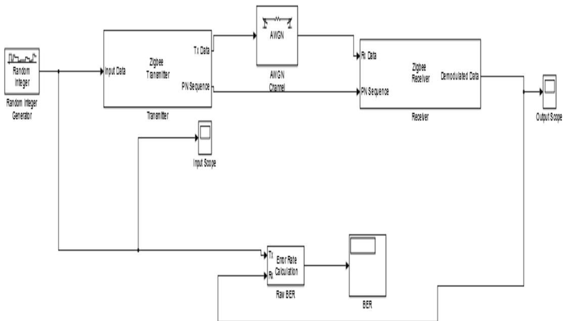
Рис. 64. Схема стандарта ZigBee 802.15.4 Simulink MATLAB 2015b
