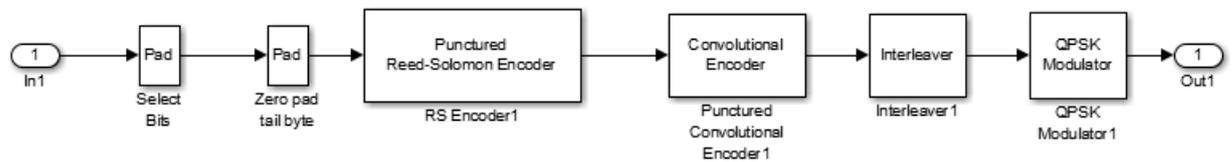
Рис. 113 – Состав блока модулятора «QPSK 1/2»
