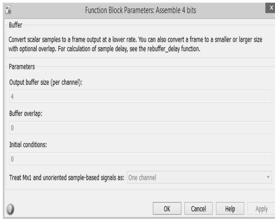
Рис. 68. Параметры блока Function block parameters: Assemble 4 bits
