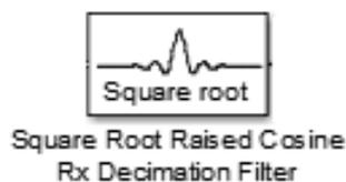
Прореживает (фильтрует) значения символа созвездия принимаемого комплекса ( I и Q).
