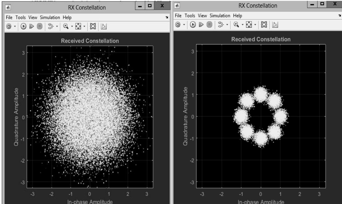
Рис. 207. Созвездие при  $E_b/N_0 = 0,5$  и  $E_b/N_0 = 6$ График зависимости  $E_b/N_0$  от BER
