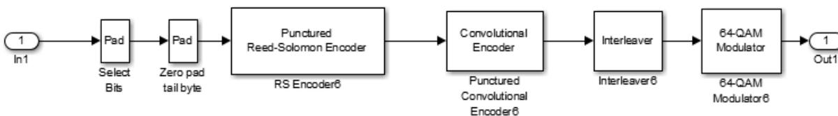
Рис. 118 – Состав блока модулятора «64QAM 3/4»
