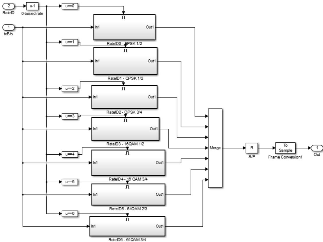
Рис. 111 – Состав блока «FEC & Modulator Bank»
