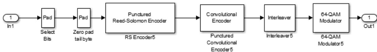
Рис. 117 – Состав блока модулятора «64QAM 2/3»
