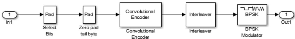
Рис. 112 – Состав блока модулятора «BPSK 1/2»
