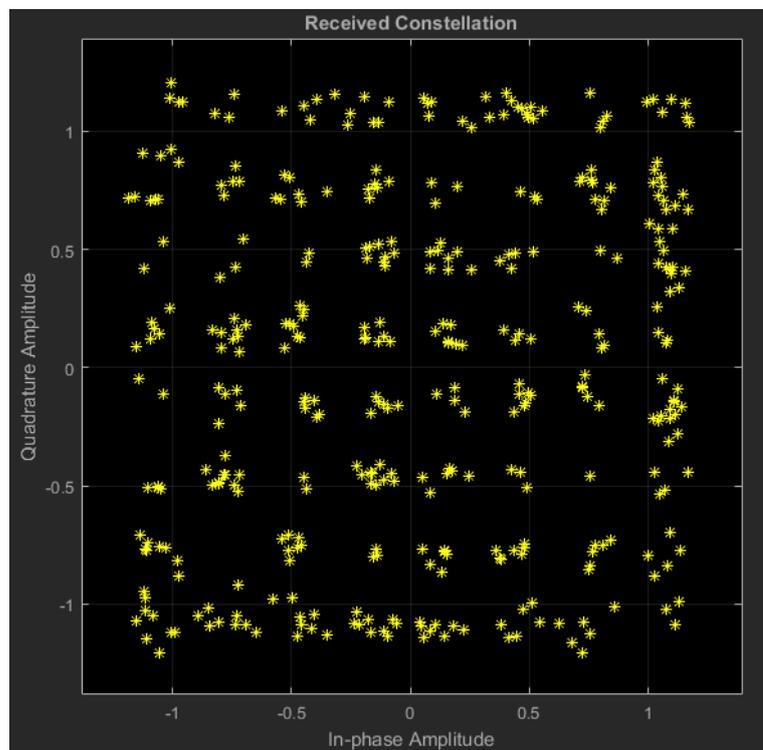
Рис. 147 – Созвездие принимаемого сигнала (SNR = 22)
