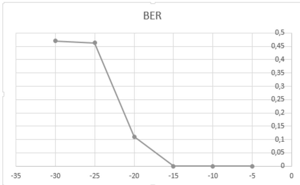
Рис. 40. Зависимость BER от SNR в канале с многолучевым распространением.
