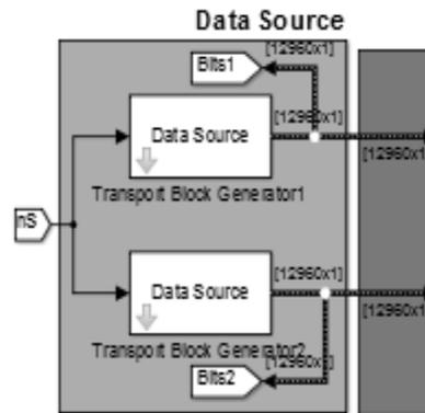
Рис. 156. Разделение исходного потока бит на параллельные потоки
