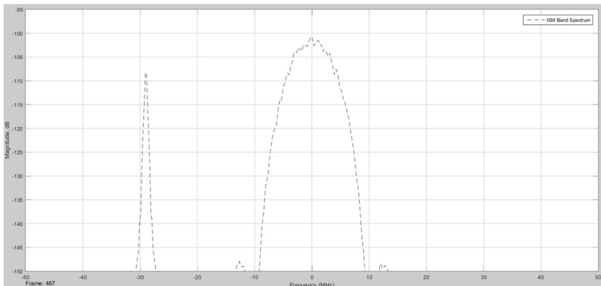
Рис. 89. Спектр Bluetooth с мешающим сигналом 802.11
