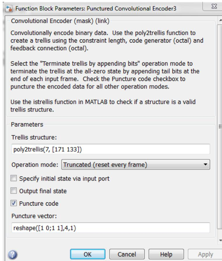
Рис. 121 – Состав блока сверточного кодера «Convolutinal Encoder 16QAM 1/2»
