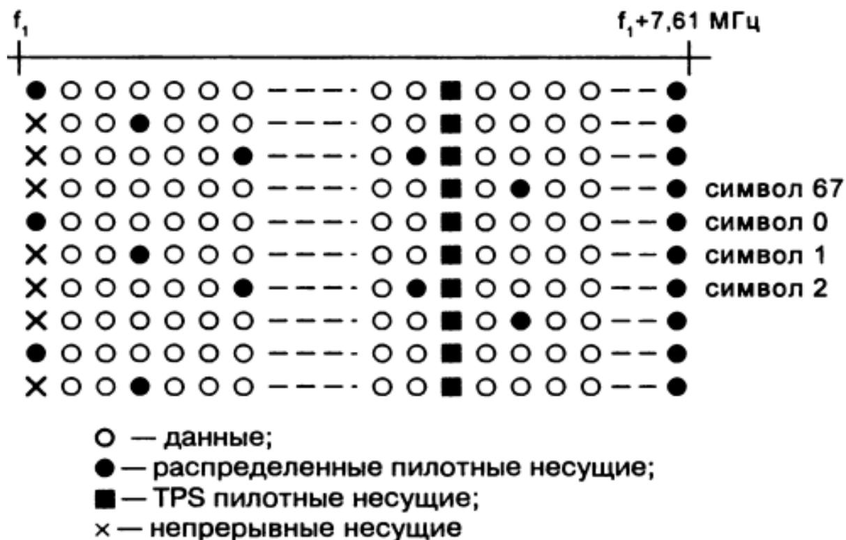
Рис. 204. Структура OFDM-символа в системе DVB-T
