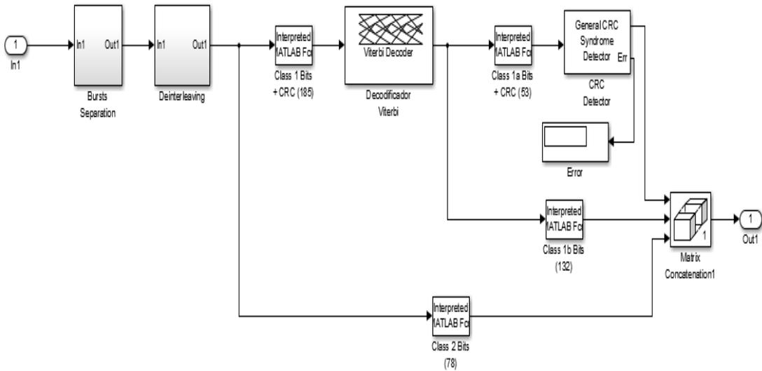
Рис. 8. Схема декодера
