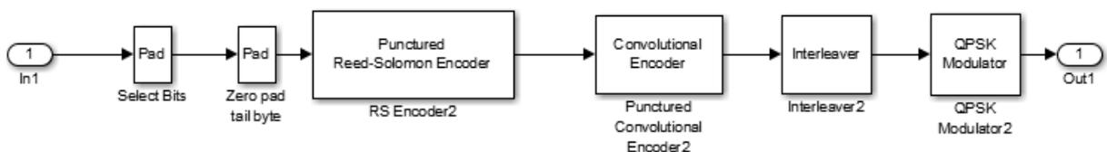
Рисунок 114 – Состав блока модулятора «QPSK 3/4»
