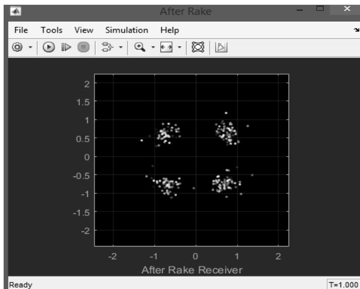
Рис. 43. Сигнал, декодированный мобильной станцией, на I-Q диаграмме
