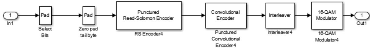
Рис. 116 – Состав блока модулятора «16QAM 3/4»
