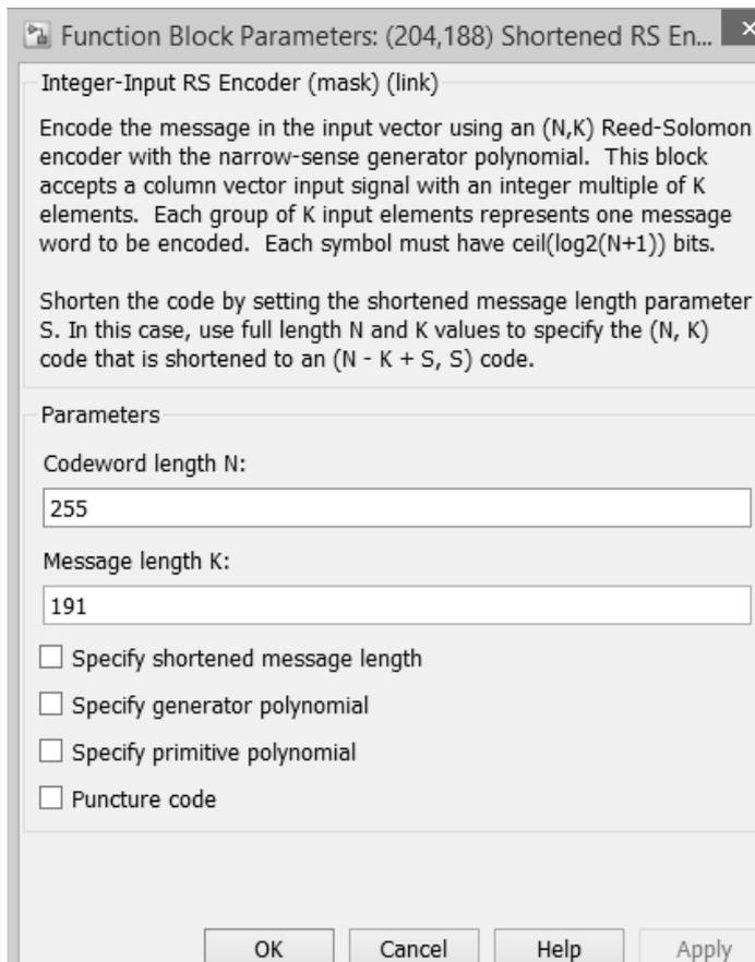
Рис. 228. Параметры RS Encoder-Decoder
