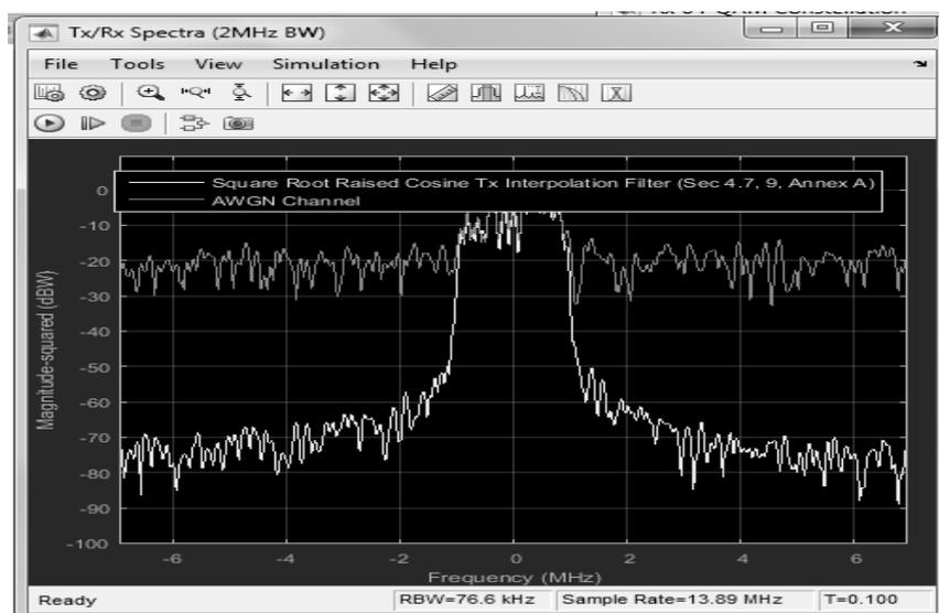
Рис. 216. Спектр передатчика и приёмника при  $E_b/N_0 = 5$  дБ.
