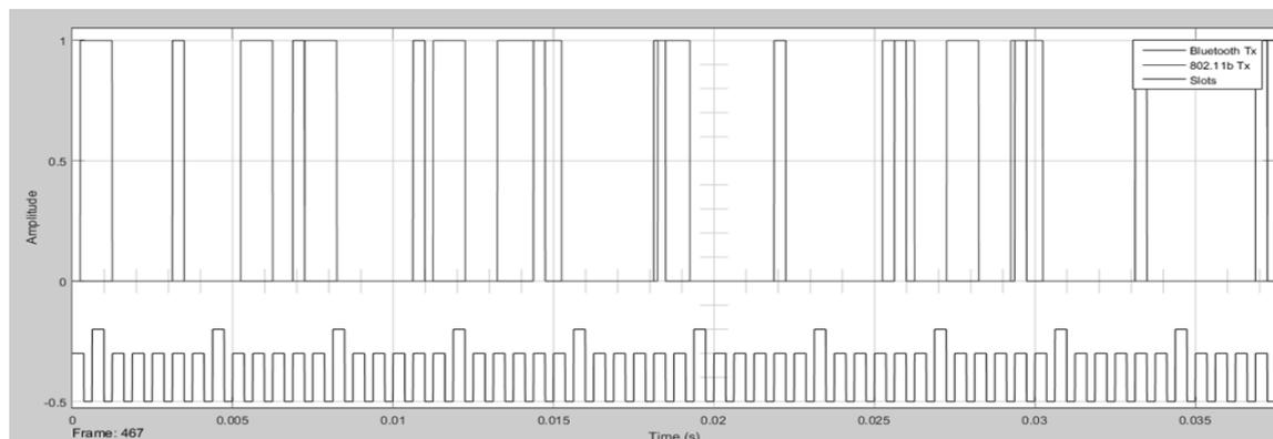
Рис. 90. Временная диаграмма Bluetooth с мешающим сигналом 802.11
