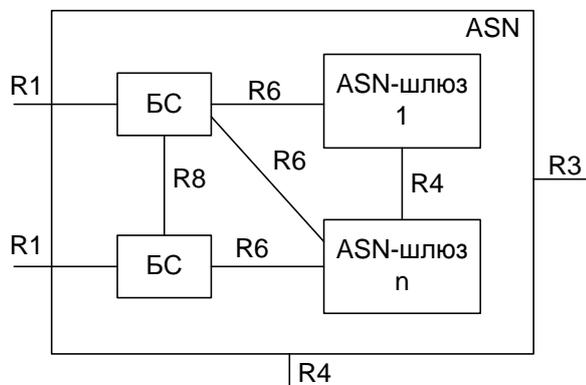
Рис. 98. Логическая модель сети доступа ASN
