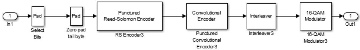
Рис. 115 – Состав блока модулятора «16QAM 1/2»
