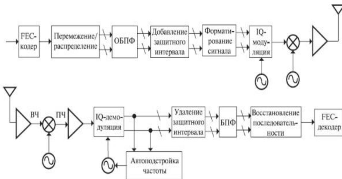
Рис. 55. Функциональная схема трактов приема/передачи стандарта IEEE 802.11a
