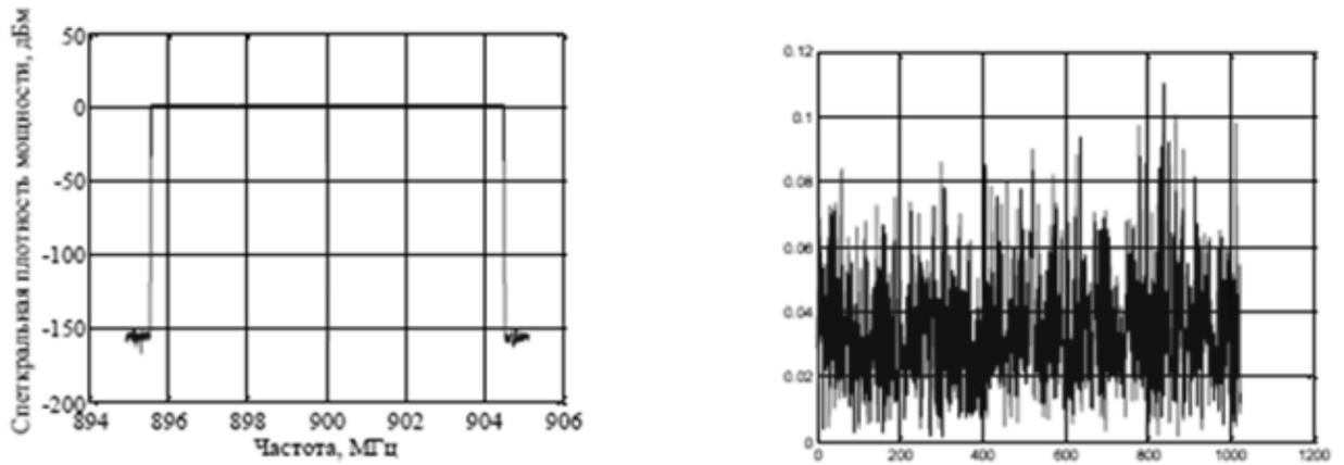
Рис. 205. Спектральное и временное представление OFDM-сигнала
