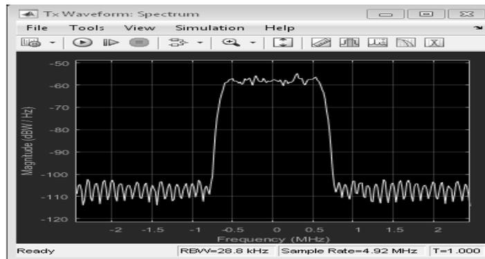
Рис. 24. Спектр сигнала сгенерированного базовой станцией.
