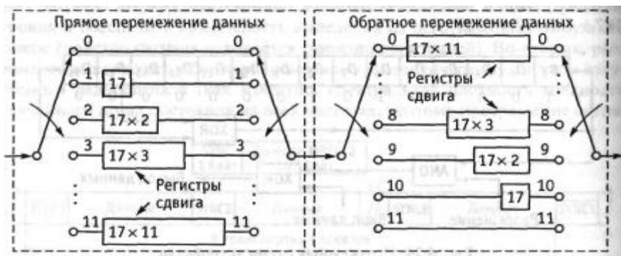
Рис. 187. Функциональная схема внутреннего перемежителя данных
