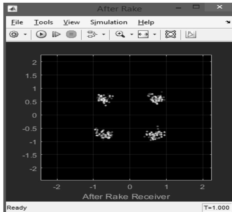
Рис. 33. Сигнал, декодированный мобильной станцией, на I-Q диаграмме
