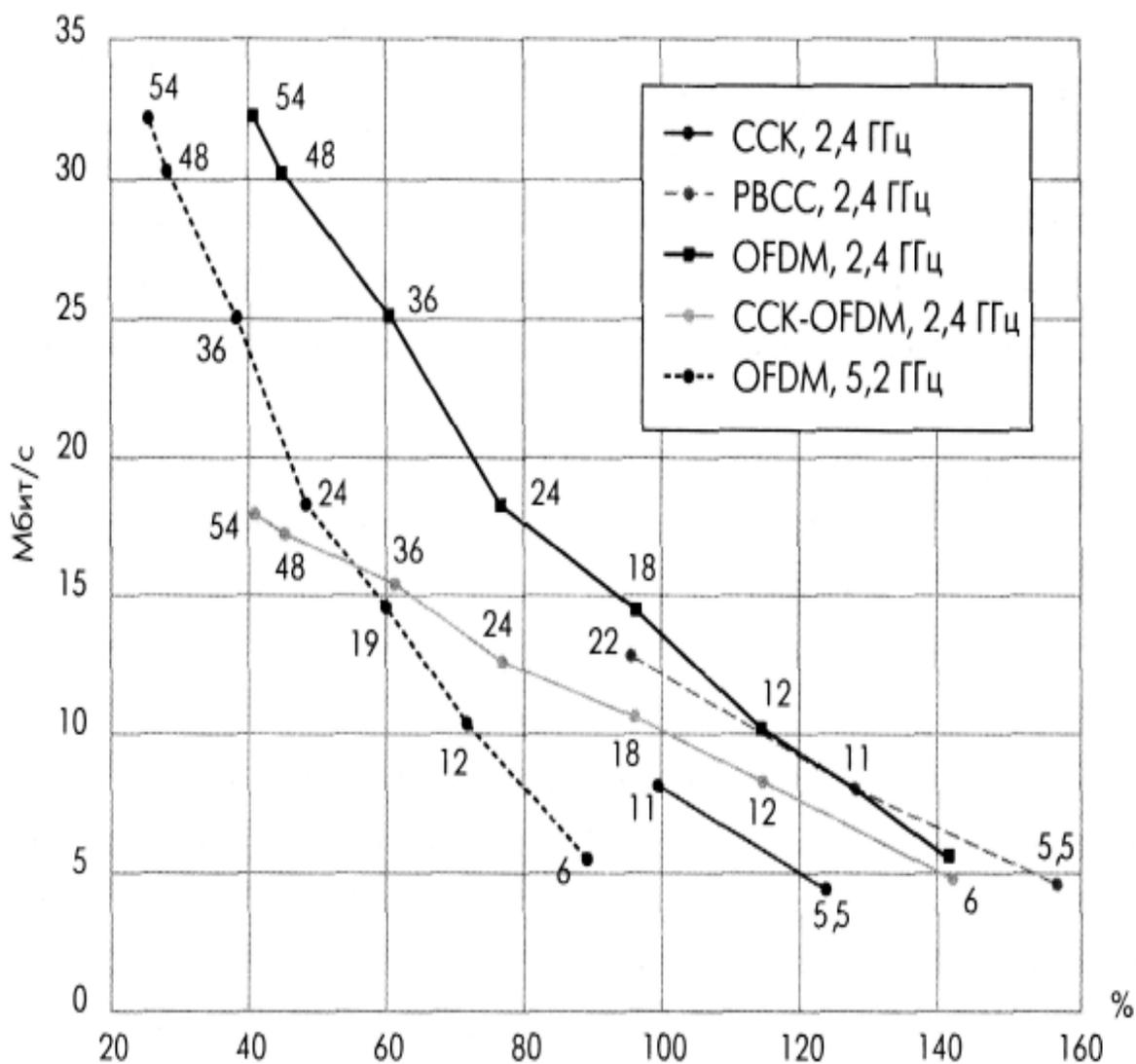
Рис. 57. Зависимость скорости передачи от расстояния для различных технологий передачи. Расстояние приведено в процентах, 100% - дальность передачи с модуляцией CCK на скорости 11 Мбит/с
