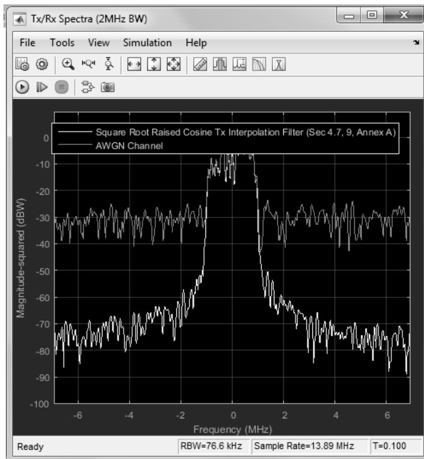
Рис. 218. Спектр передатчика и приёмника при  $E_b/N_0 = 15$  дБ.
