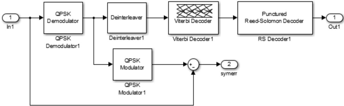
Рис. 126 – Состав блока демодулятора «QPSK 1/2»
