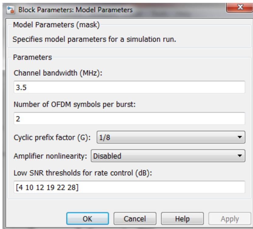
Рис. 110 – Параметры системы, изменяемые в блоке «Model Parameters»
