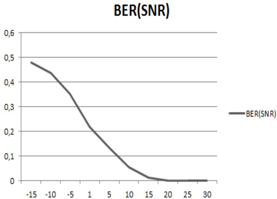
Рис. 174. Зависимость битовой вероятности ошибки от отношения сигнал/шум для первого потока
