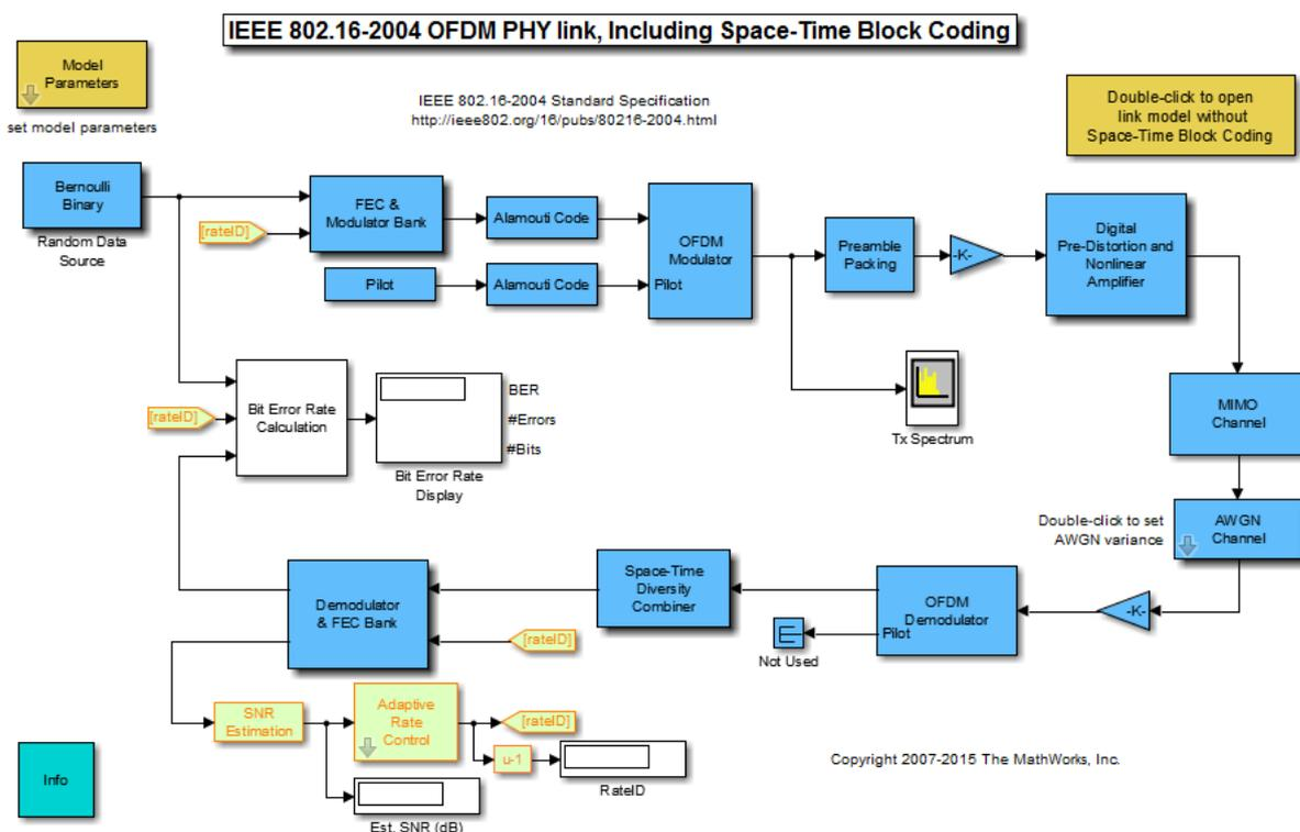
Рис. 107 – Модель IEEE 802.16-2004 OFDM в MATLAB 2015b
