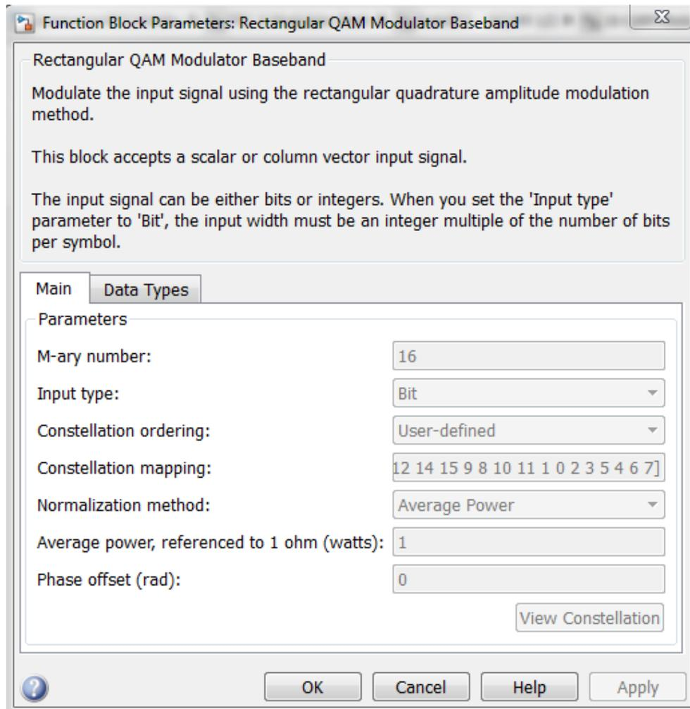
Рисунок 123 – Состав блока модулятора «16-QAM Modulator 16QAM 1/2»
