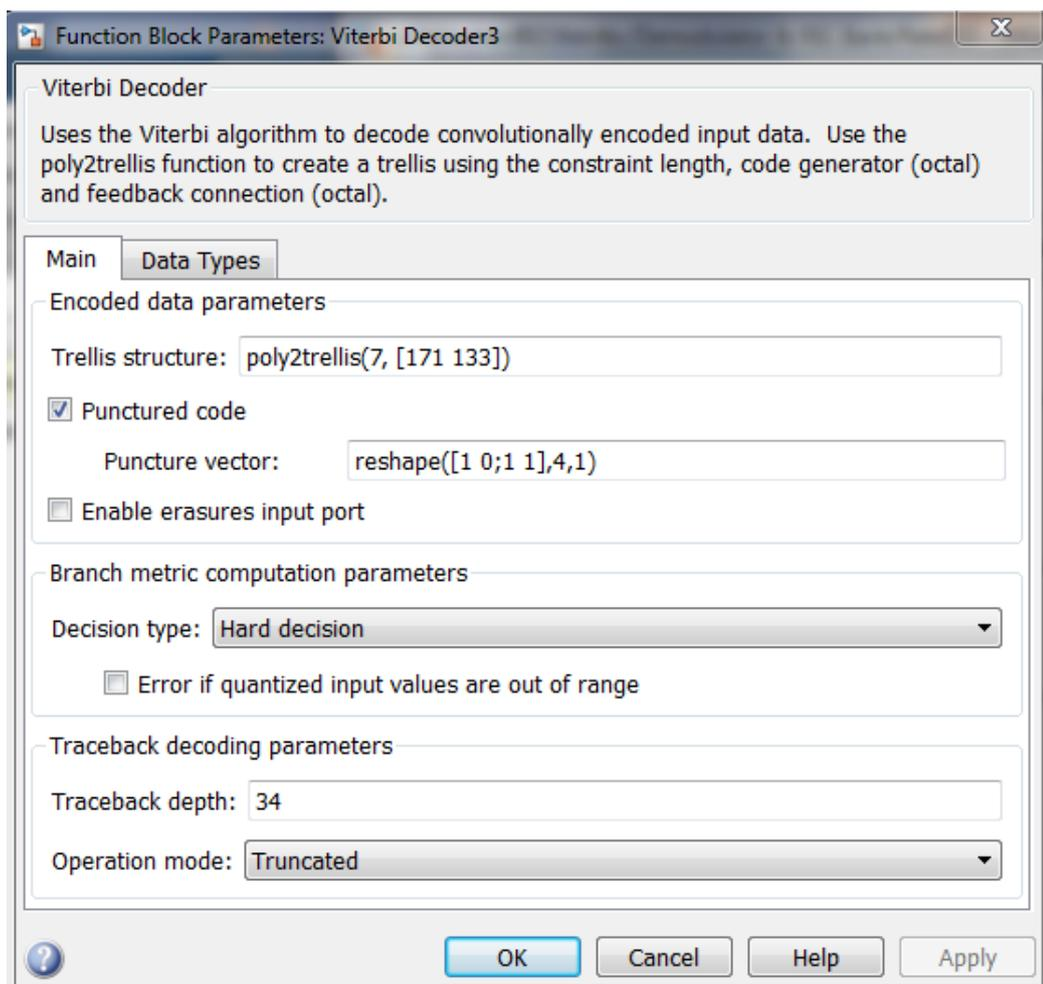
Рис. 135 – Состав блока декодера Витерби «Viterbi Decoder 16QAM 1/2»
