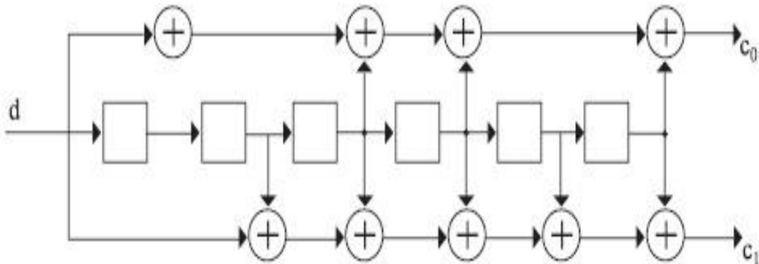
Рис. 52. Сверточное кодирование с двумя битами кодовой последовательности
