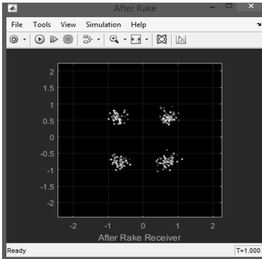
Рис. 35. Сигнал, декодированный мобильной станцией, на I-Q диаграмме.
