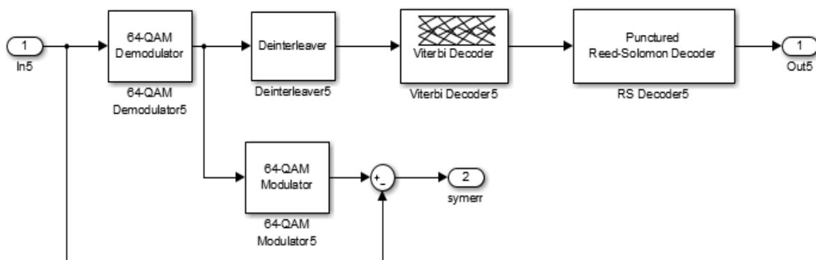
Рис. 130 – Состав блока демодулятора «64QAM 2/3»
