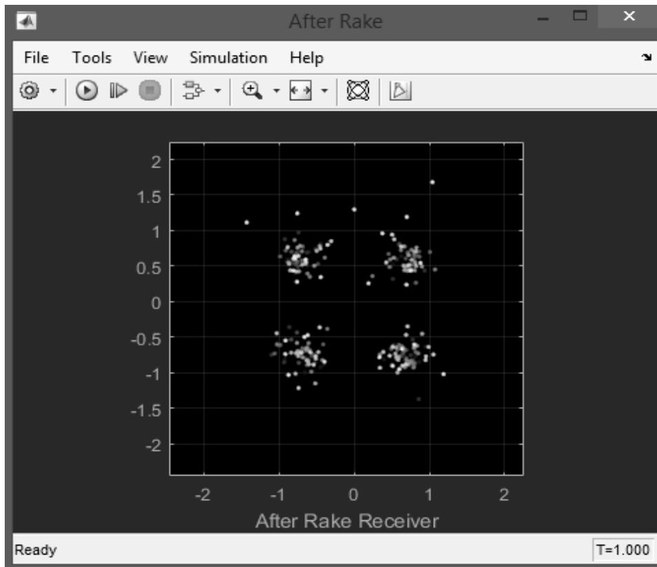
Рис. 39. Сигнал, декодированный мобильной станцией, на I-Q диаграмме.
