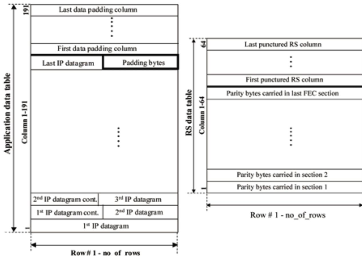
Рис. 224. Кодирование пакетов кодом Рида-Соломона
