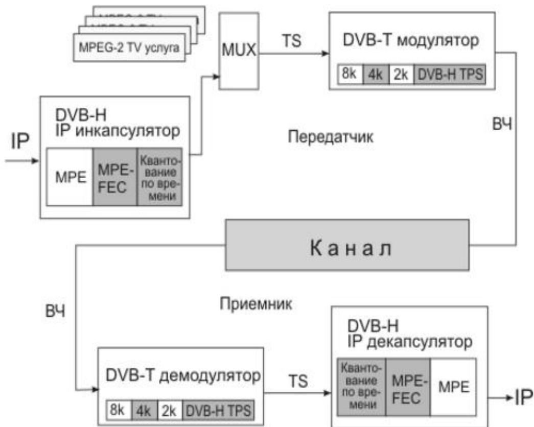
Рис. 222. Обобщенная архитектура системы DVB-H
