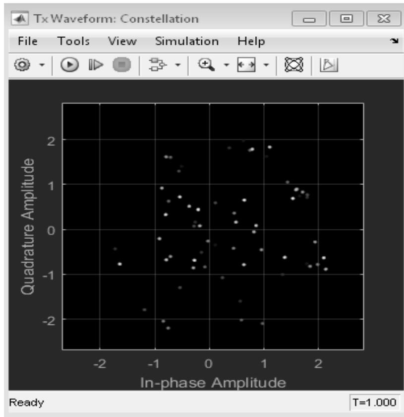
Рис. 25. Сгенерированный базовой станцией сигнал на I-Q диаграмме
