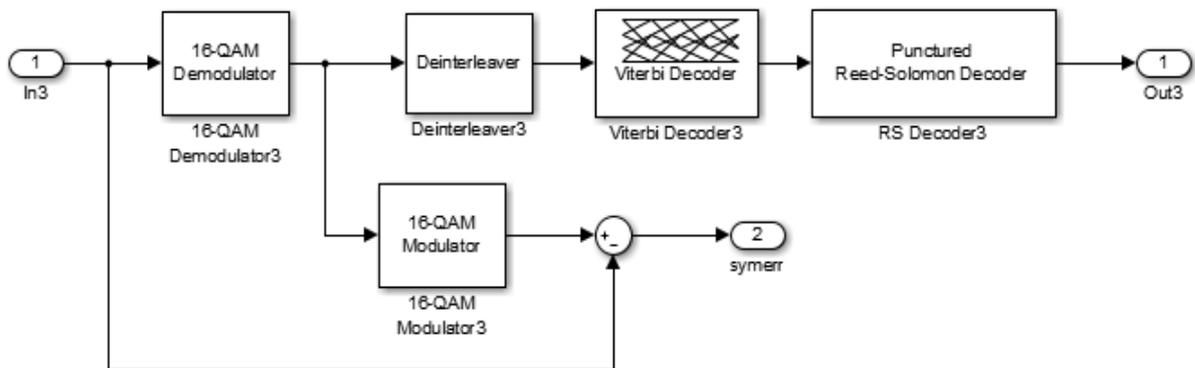
Рис. 128 – Состав блока демодулятора «16QAM 1/2»
