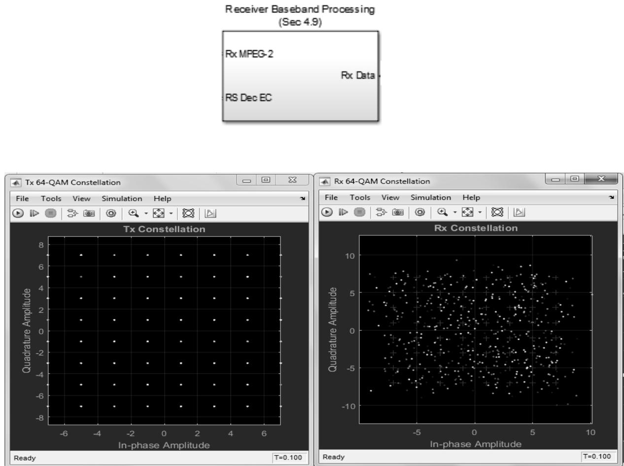
Рис. 215. Созвездия передатчика и приёмника при  $E_b/N_0 = 5$  дБ.
