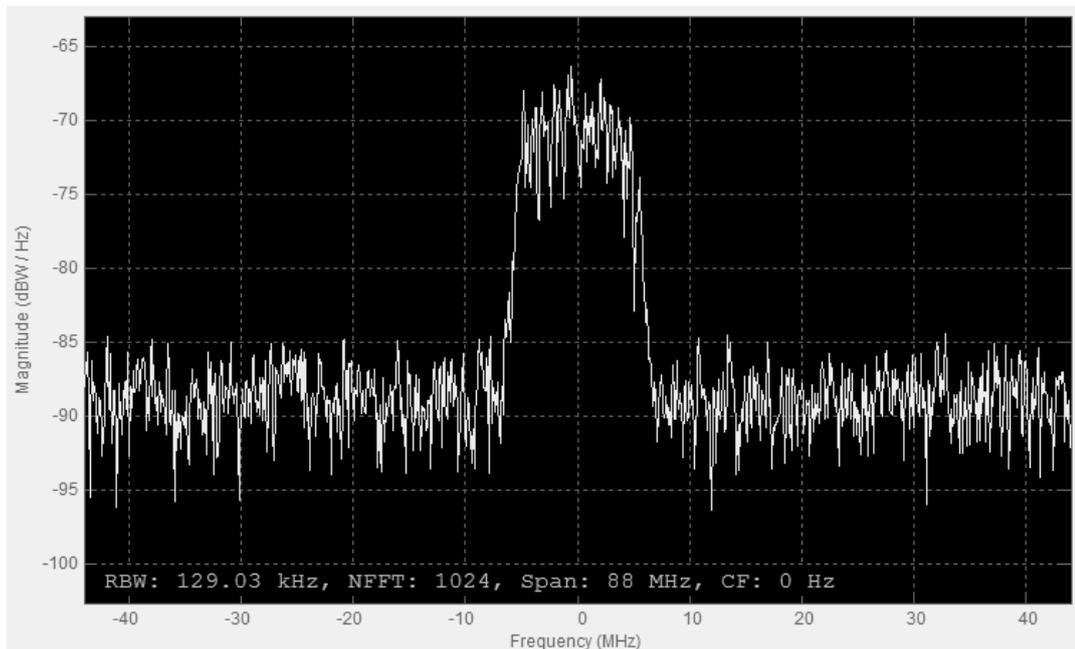
Рис. 59. Частотная характеристика для скорости передачи 11 Мбит/с
