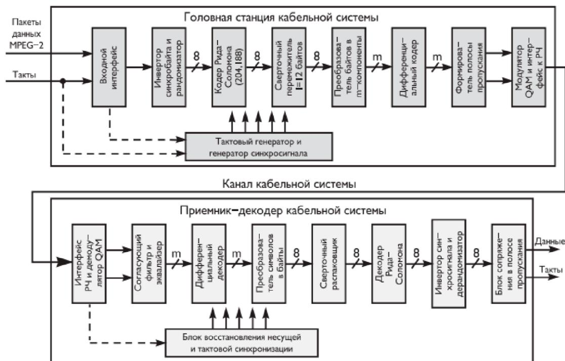
Рис. 209. Структурная схема системы цифрового кабельного телевидения DVB-C
