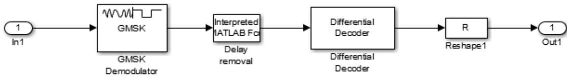
Рис. 7. Схема демодулятора
