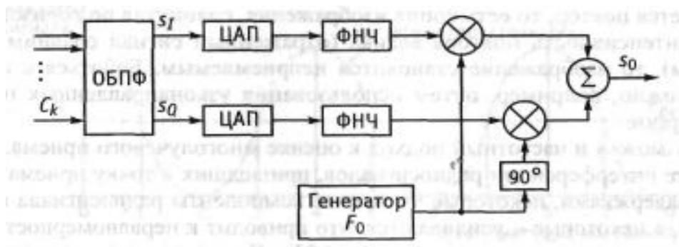
Рис. 203. Структурная схема формирователя OFDM-символа в системе DVB-T
