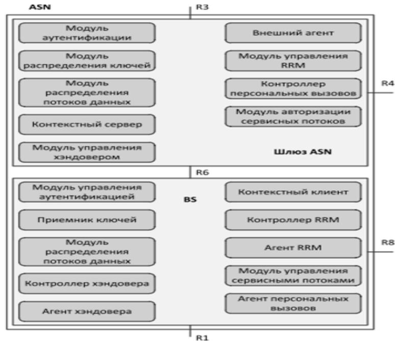
Рис. 99. Архитектура профиля С
