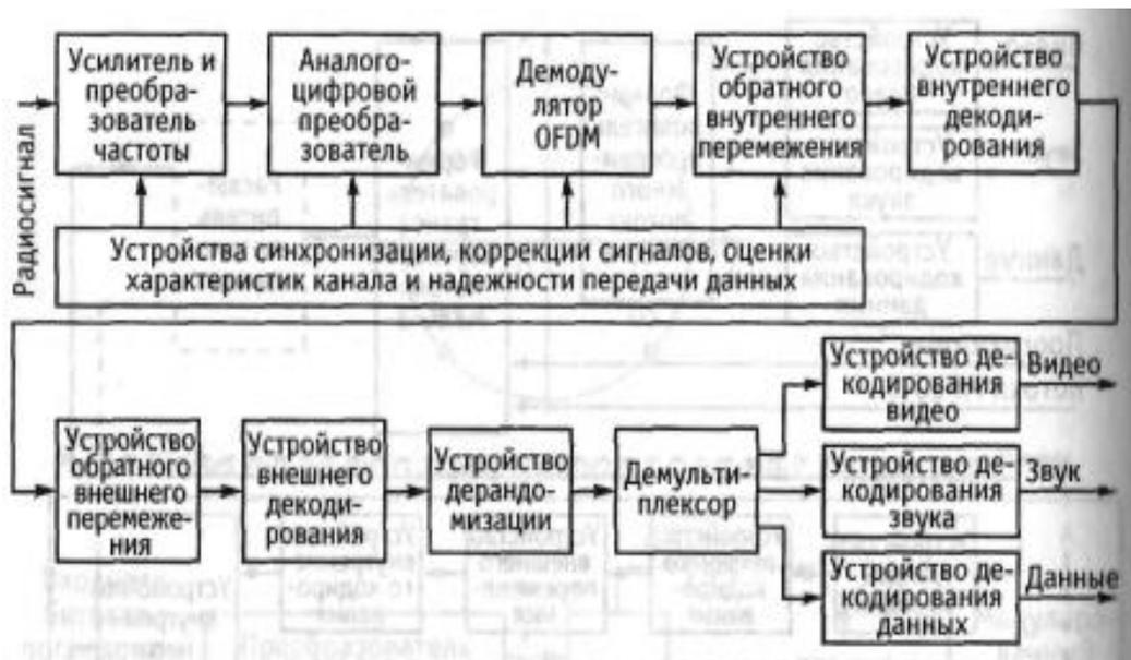
Рис. 184. Структурная схема приемника системы DVB-T
