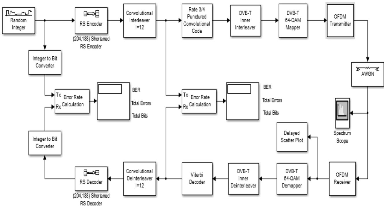
Рис.206. Функциональная схема системы DVB-T реализованная в Matlab
