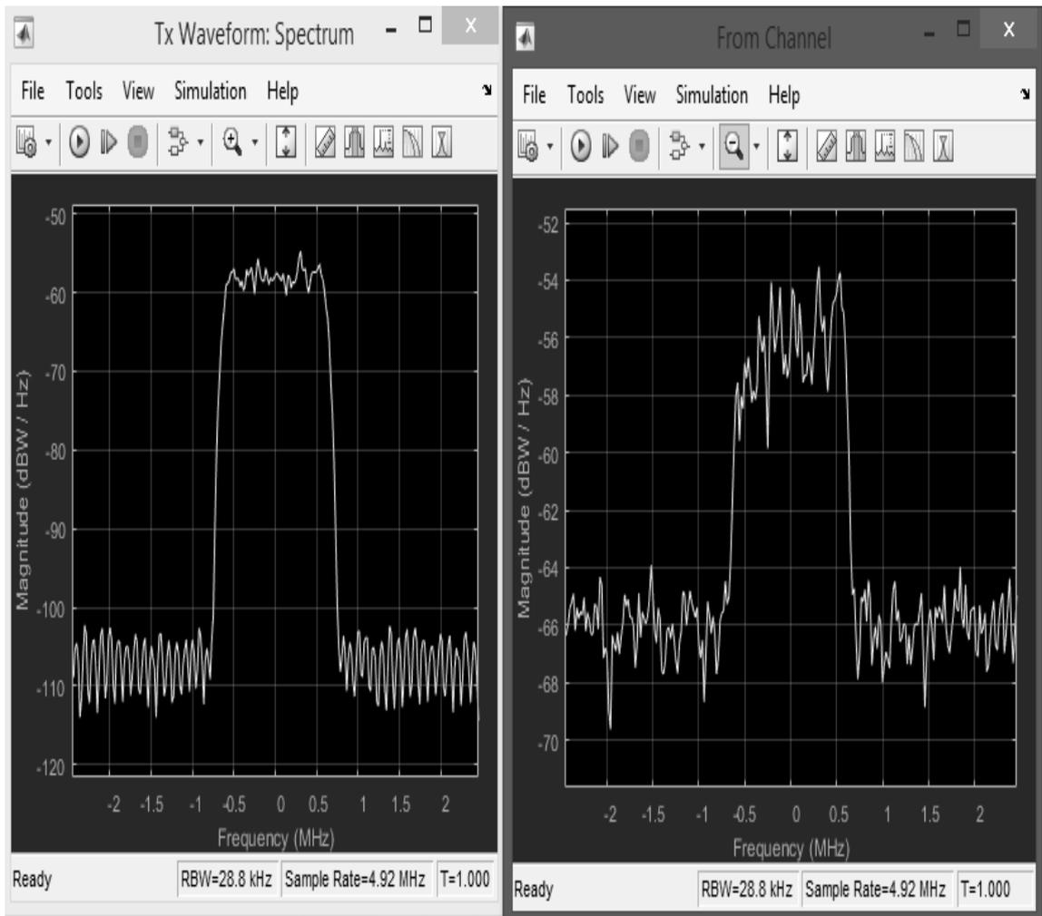
Рис. 42. Спектры сигнала до и после канала при отношении сигнал/шум 5
