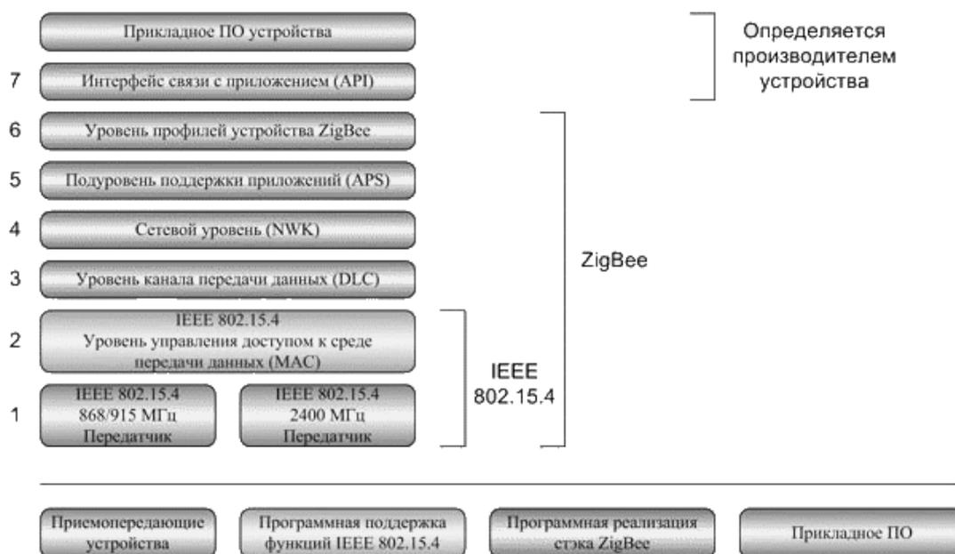
Рис. 63. Многоуровневая модель стандарта связи ZigBee
