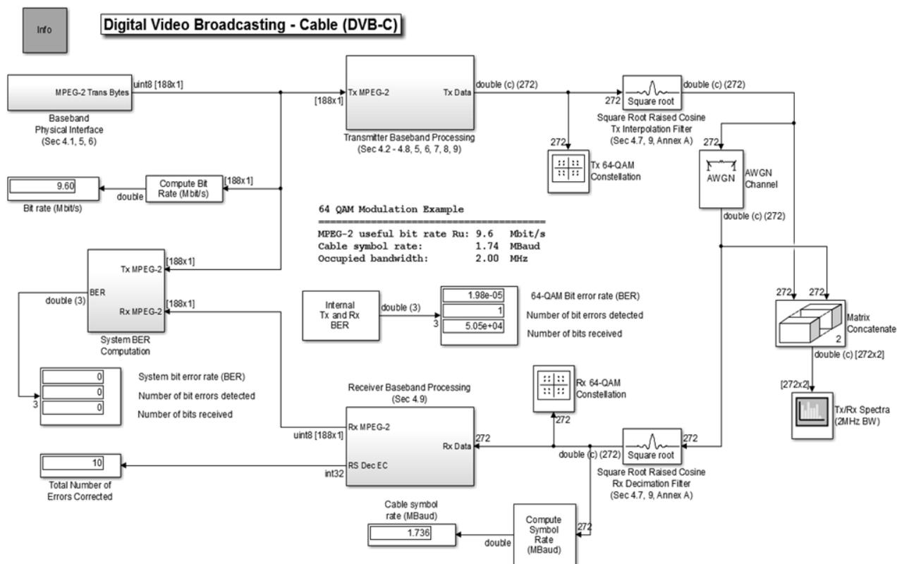
Рис. 210. Структурная схема системы цифрового кабельного телевидения DVB-C в Simulink MATLAB
