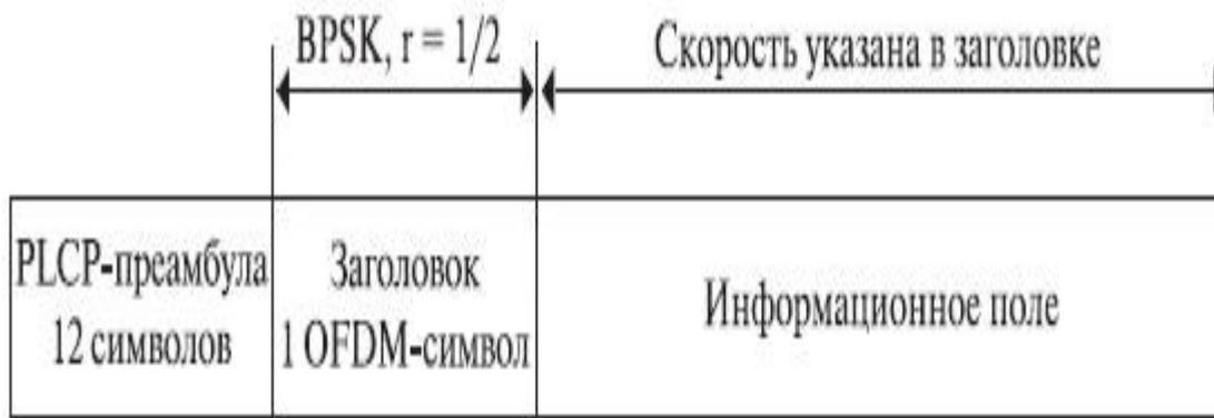
Рис. 54. Структура заголовка физического уровня стандарта IEEE 802.11a
