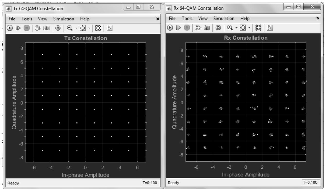
Рис. 219. Созвездия передатчика и приёмника при  $E_b/N_0 = 19$  дБ.
