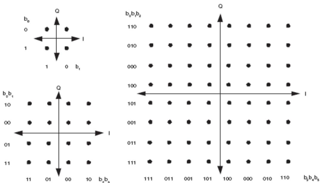
Рис. 202. Виды модуляции используемые в системе DVB-T
