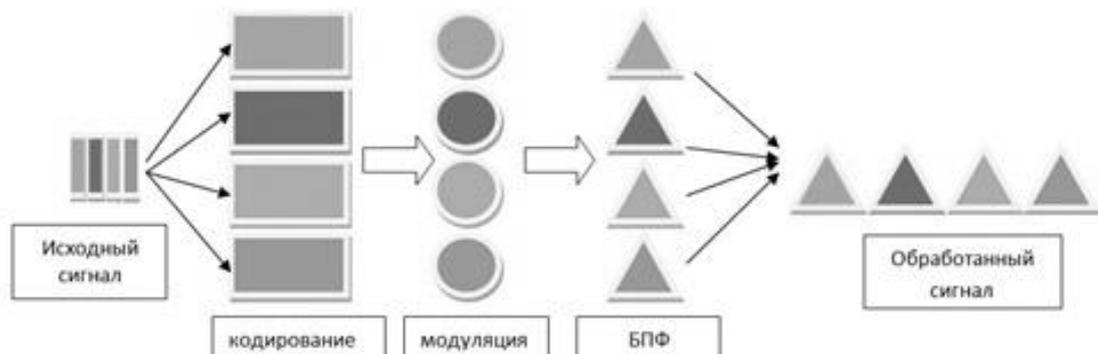
Рис. 157. OFDM – модулятор
