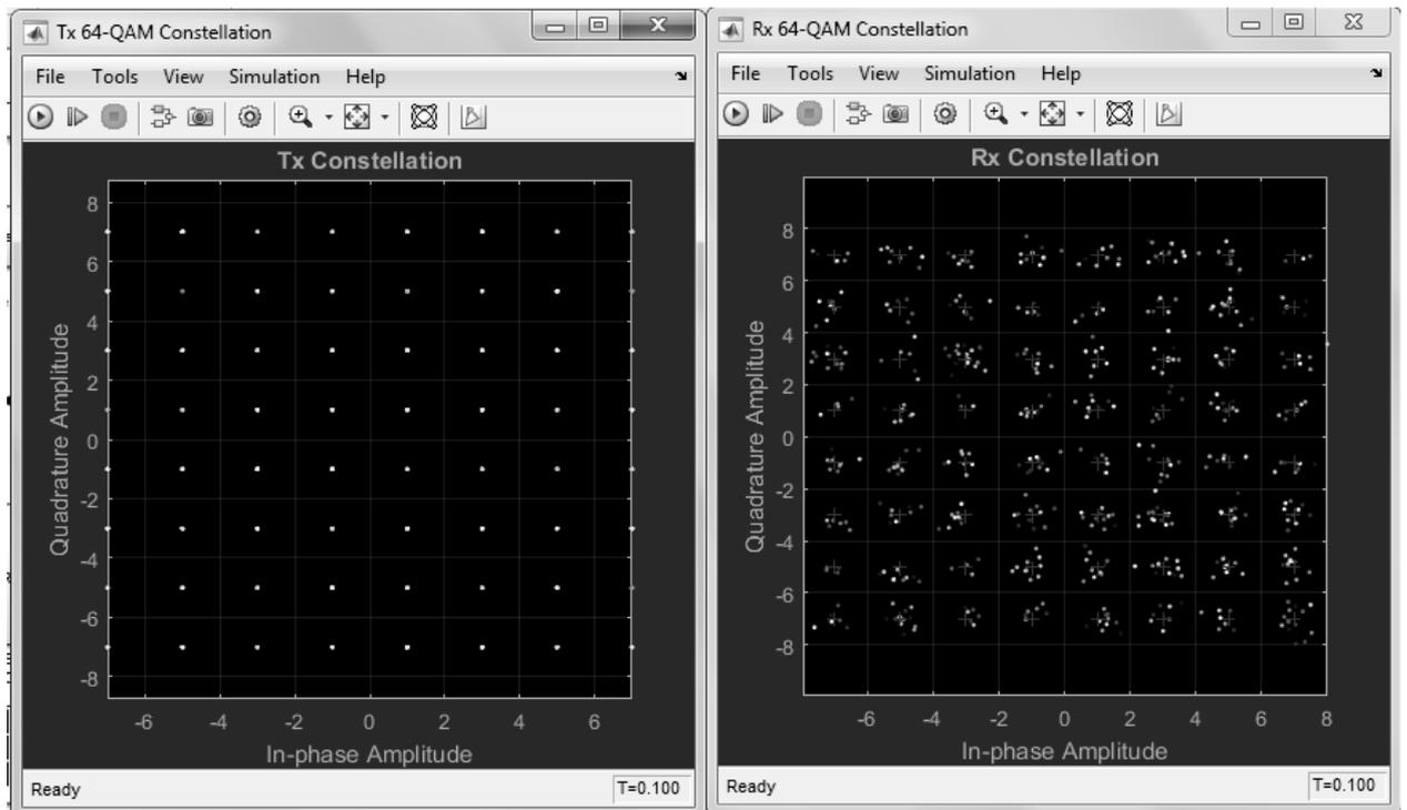
Рис. 217. Созвездия передатчика и приёмника при  $E_b/N_0 = 15$  дБ.
