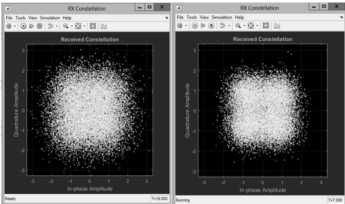
Рис. 204. Созвездие при  $E_b/N_0 = 0.5$  и  $E_b/N_0 = 3.5$
