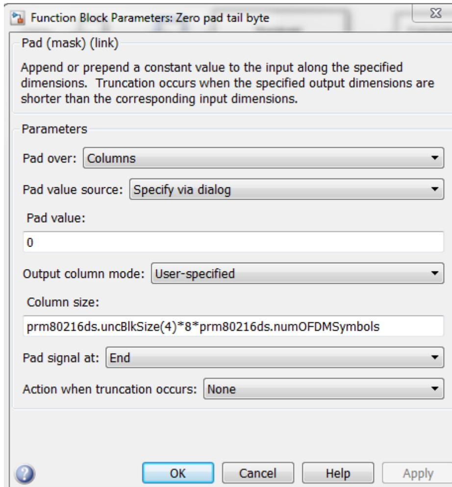
Рис. 119 – Состав блока «Zero pad tail byte 16QAM 1/2»
