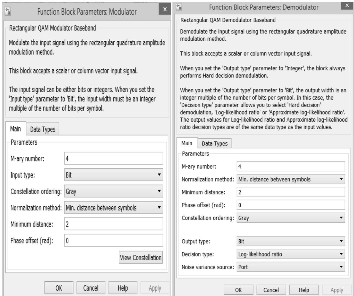
Рис. 230. Параметры QPSK модулятора
