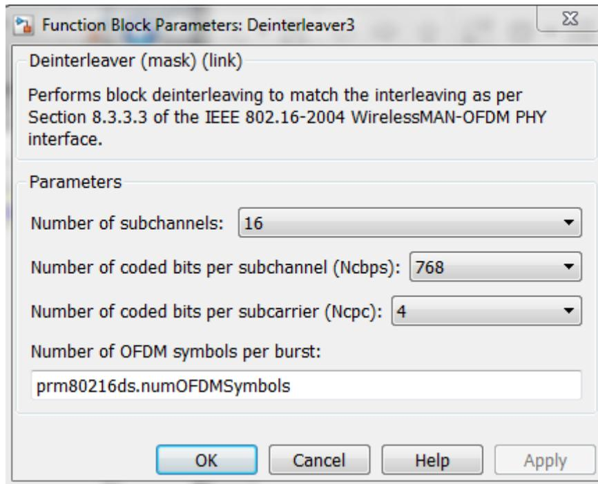
Рис. 134 – Состав блока деперемежителя «Deinterleaver 16QAM 1/2»
