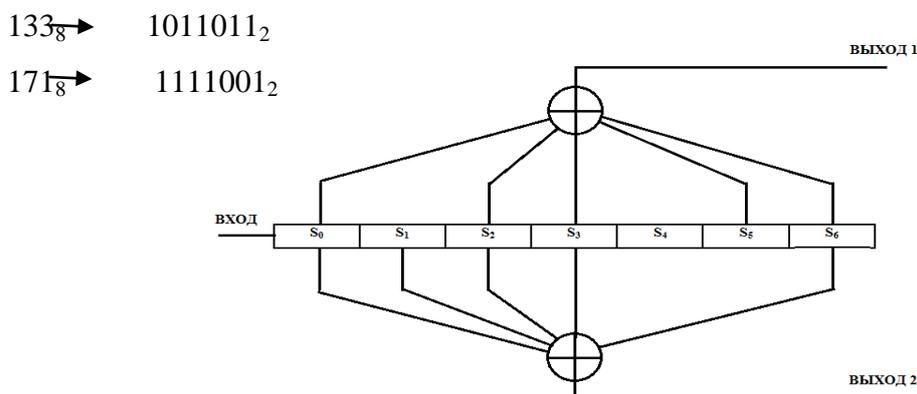
Рис. 189. Функциональная схема сверточного кодера 133,171
