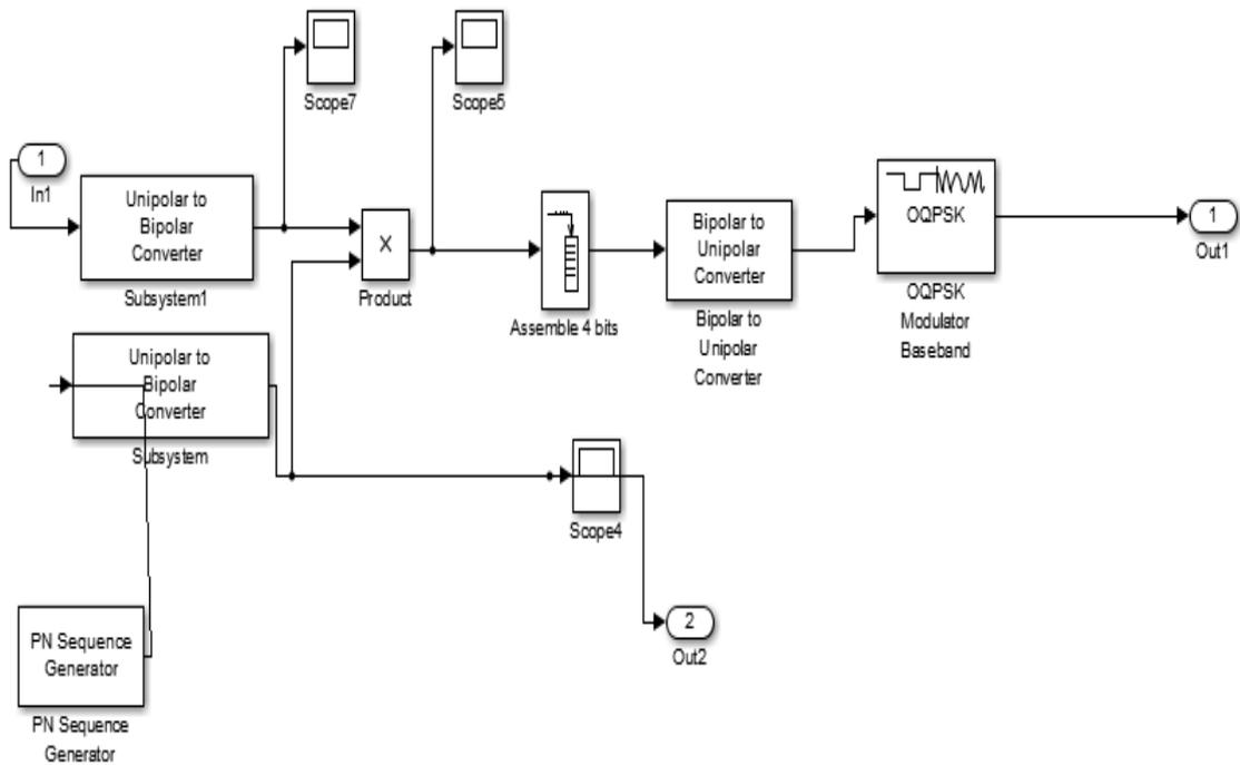
Рис. 66. Схема ZigBeeTransmitter
