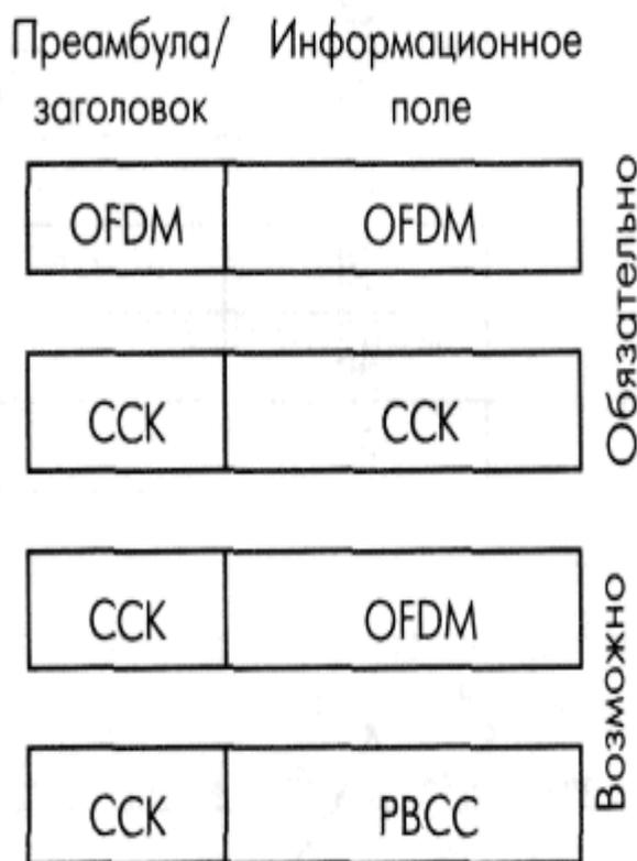
Рис. 56. Кадры IEEE 802.11g в различных режимах модуляции
