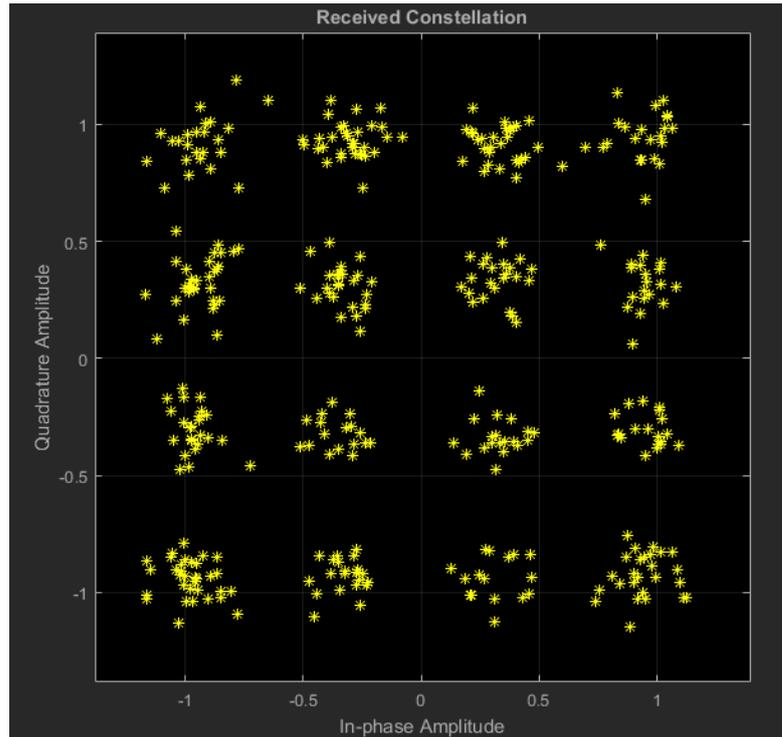
Рисунок 146 – Созвездие принимаемого сигнала (SNR = 18)
