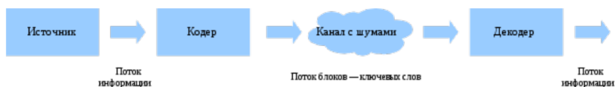
Рис. 3.119. Упрощенная схема передачи информации по каналу связи.
