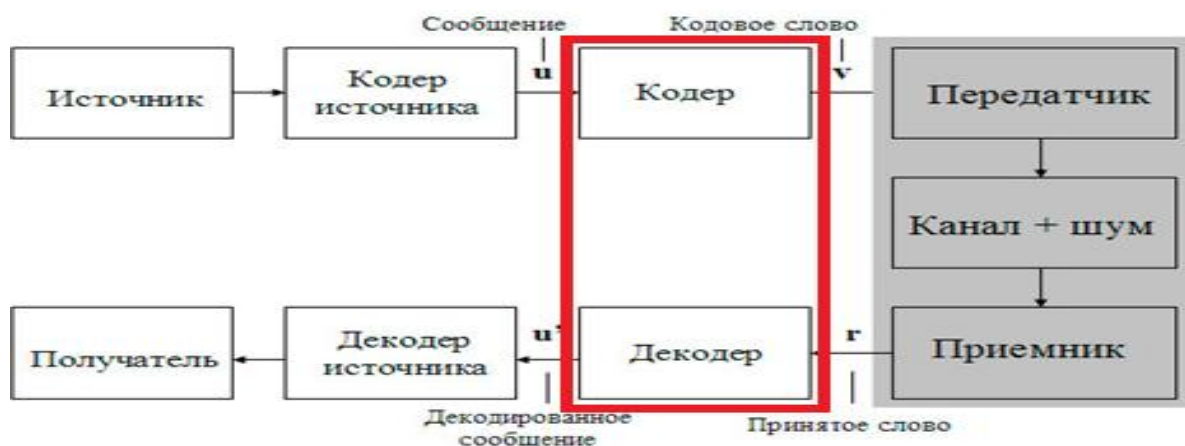
Рис. 3.1. Структурная схема системы передачи дискретной информации
