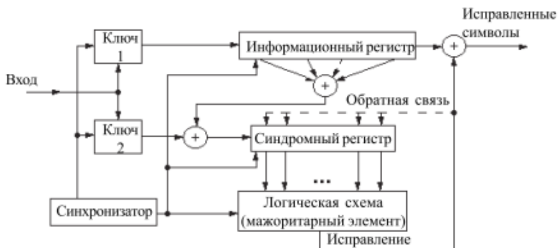
Рис. 3.70. Общая схема декодера для сверточного кода
