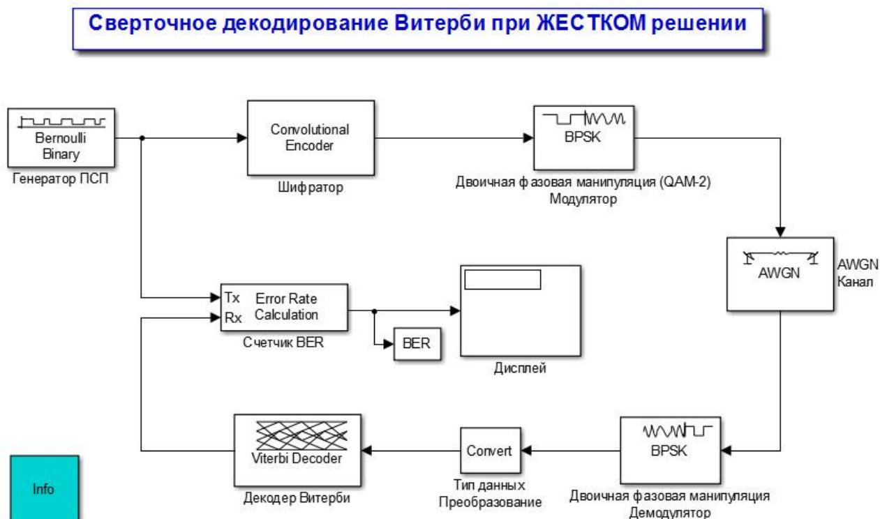
Рис. 6 – Модель сверточного декодера Витерби при «Жестком решении»
