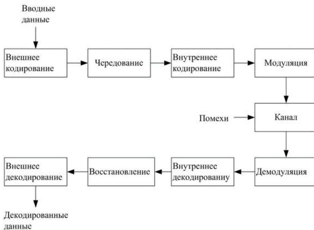
Рис. 3.139. Обобщенная структурная схема исследования каскадных кодов
