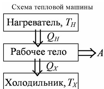
Рассмотрим принцип действия реальной тепловой машины на примере одного цикла. Рабочее тело (газ) приводится в контакт с нагревателем, который находится при температуре  $T_H$ . В ходе нагревания рабочего тела до температуры  $T_H$ , оно получает от нагревателя теплоту  $Q_H$ , которая частично превращается в механическую работу  $A$ .
