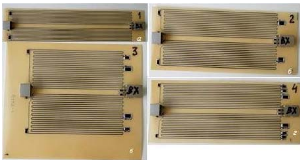
Рисунок 5.15 – Фотографии макетов модальных фильтров с числом каскадов 1, 2, 3, 4
