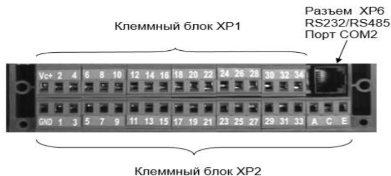
Рисунок 2 - Клеммные блоки XP1 и XP2.
