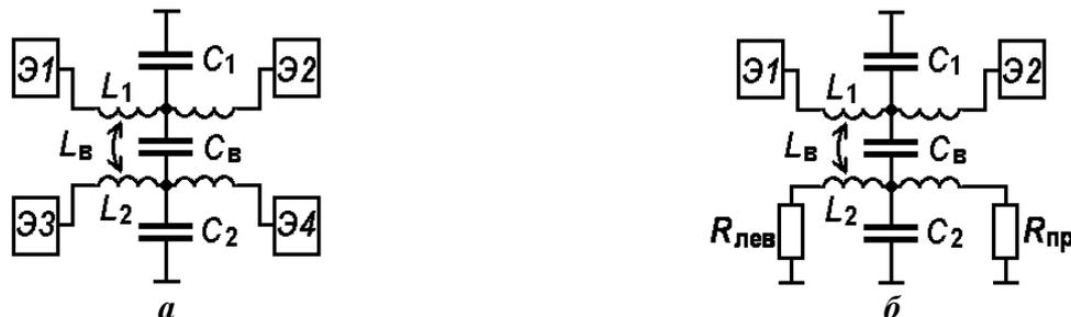
Рис. 5.3.2. Схема взаимодействующих цепей связи с сосредоточенными параметрами (*a*), после линеаризации входных и выходных характеристик логических элементов пассивной цепи (*б*)
