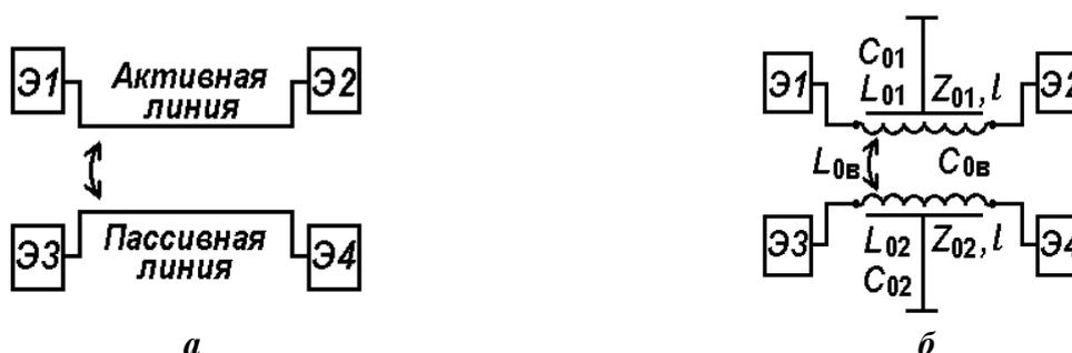
Рис. 5.3.1. Схема взаимодействующих цепей связи с распределенными параметрами:
