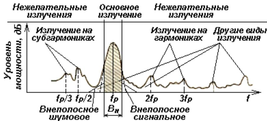
Рис. 2.1.3. Общий спектр излучения передатчика
