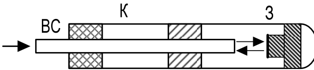
Рис. 5.12. Схема измерителя температуры на основе встроенного ИФП
