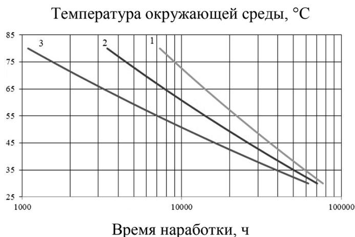
Зависимость срока службы от температуры для: лампы с одним СИЭ – 1; лампа с двумя СИЭ – 2; лампа с четырьмя СИЭ – 3
