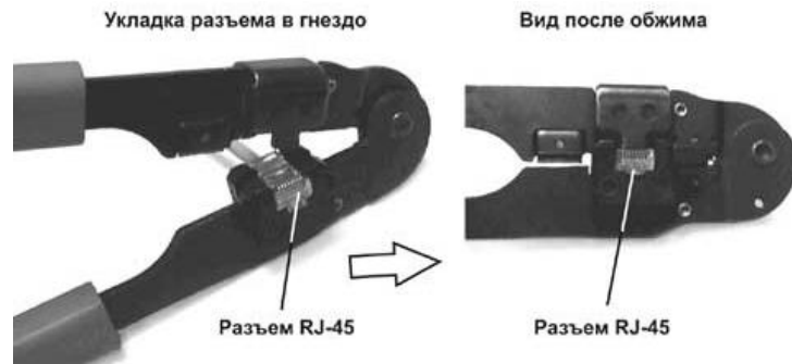
Рисунок 1.6 – Обжим кабеля в соединителе 8P8C (RJ-45)
