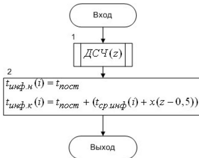
Рис.2.35 – Алгоритм моделирования события «Передача информации»
