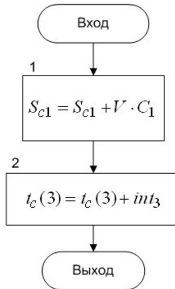
Рис.3.26 - Алгоритм процедуры моделирования второго события – «Расчет затрат на хранение»
