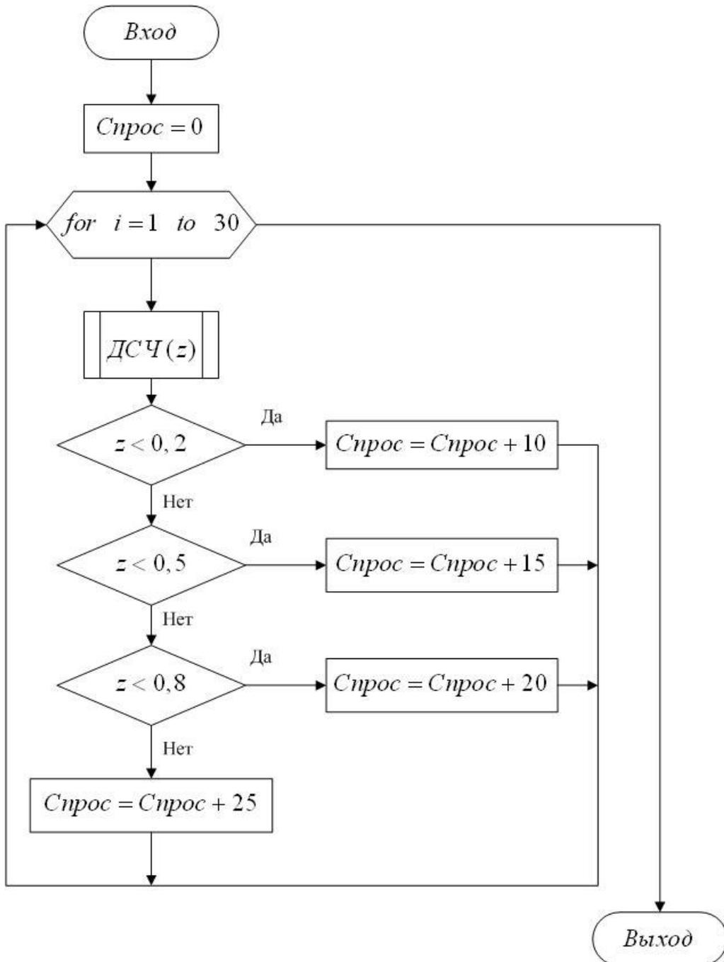
Рис. 1.10 – Алгоритм моделирования спроса на товар за месяц
