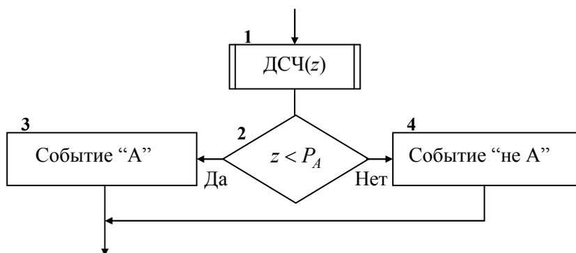
Рис.1.1 – Моделирование простого события
