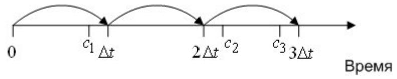
Рис.2 – Продвижение времени посредством постоянного шага
