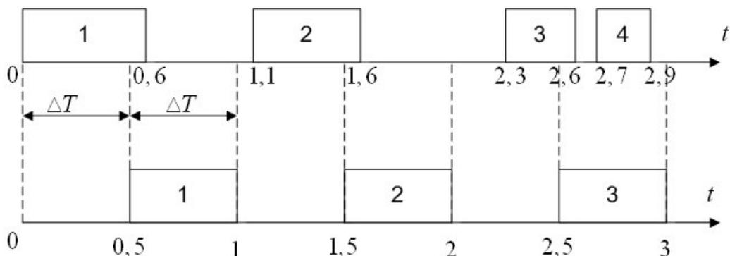
Рис.2.17 – Моделирование обслуживания методом  $\Delta T$
