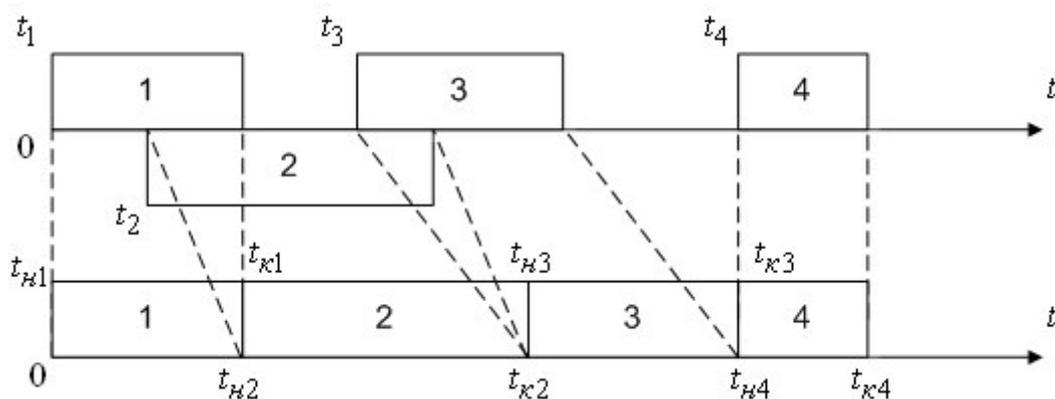
Рис.2.6 – Последовательная проводка заявок
