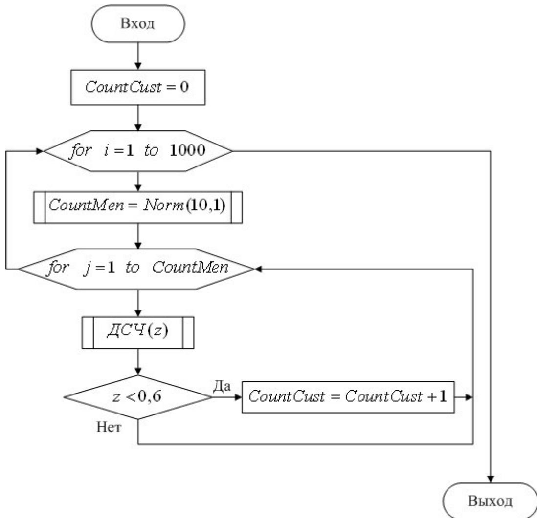
Рис.1.16 – Алгоритм моделирования распространения информации о товаре
