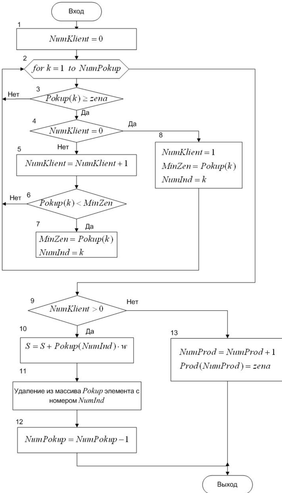
Рис.1.20 – Алгоритм имитации события поступления заявки на продажу
