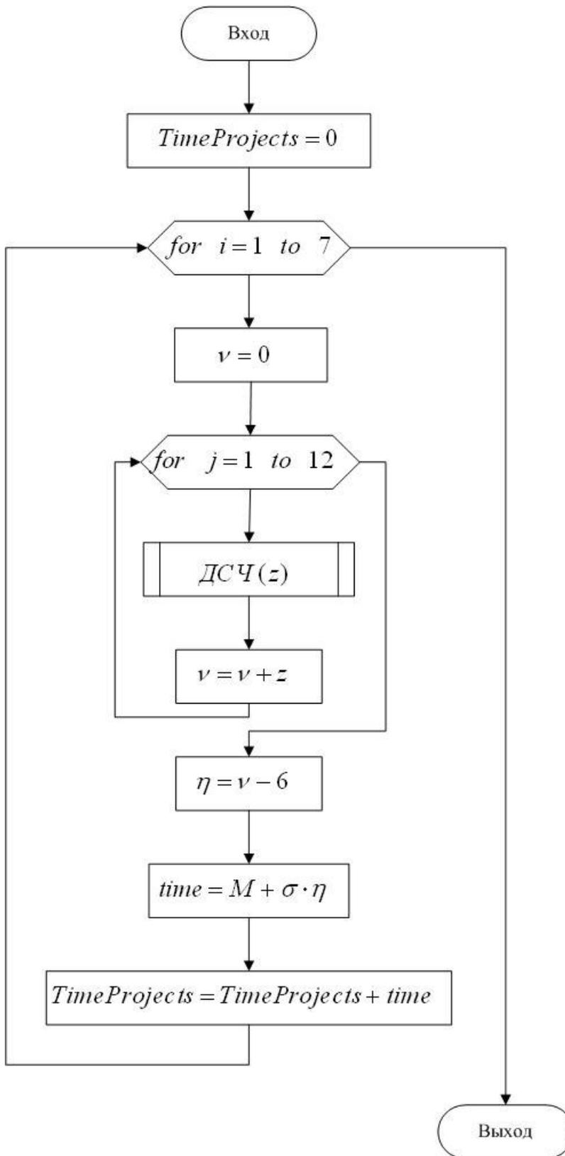
Рис. 1.12 –Алгоритм определения времени окончания 7- го проекта
