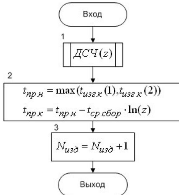
Рис.2.37 – Алгоритм моделирования события «Сборка изделия»
