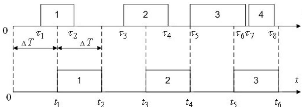
Рис.2.5 – Моделирование неперекрывающихся заявок и анализ системы через равные промежутки времени  $\Delta T$
