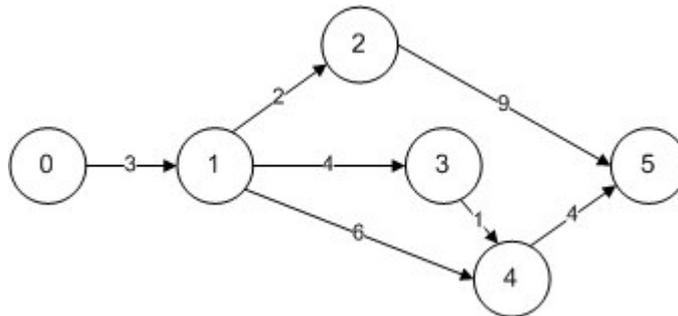
Рис.4.5 – Сетевой график
