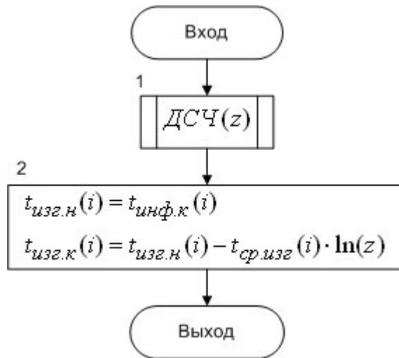
Рис.2.36 – Алгоритм моделирования события «Изготовление детали»
