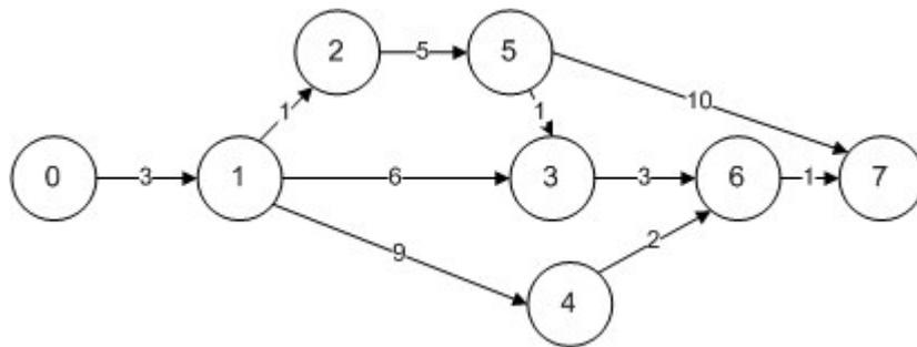
Рис.4.4 – Сетевой график
