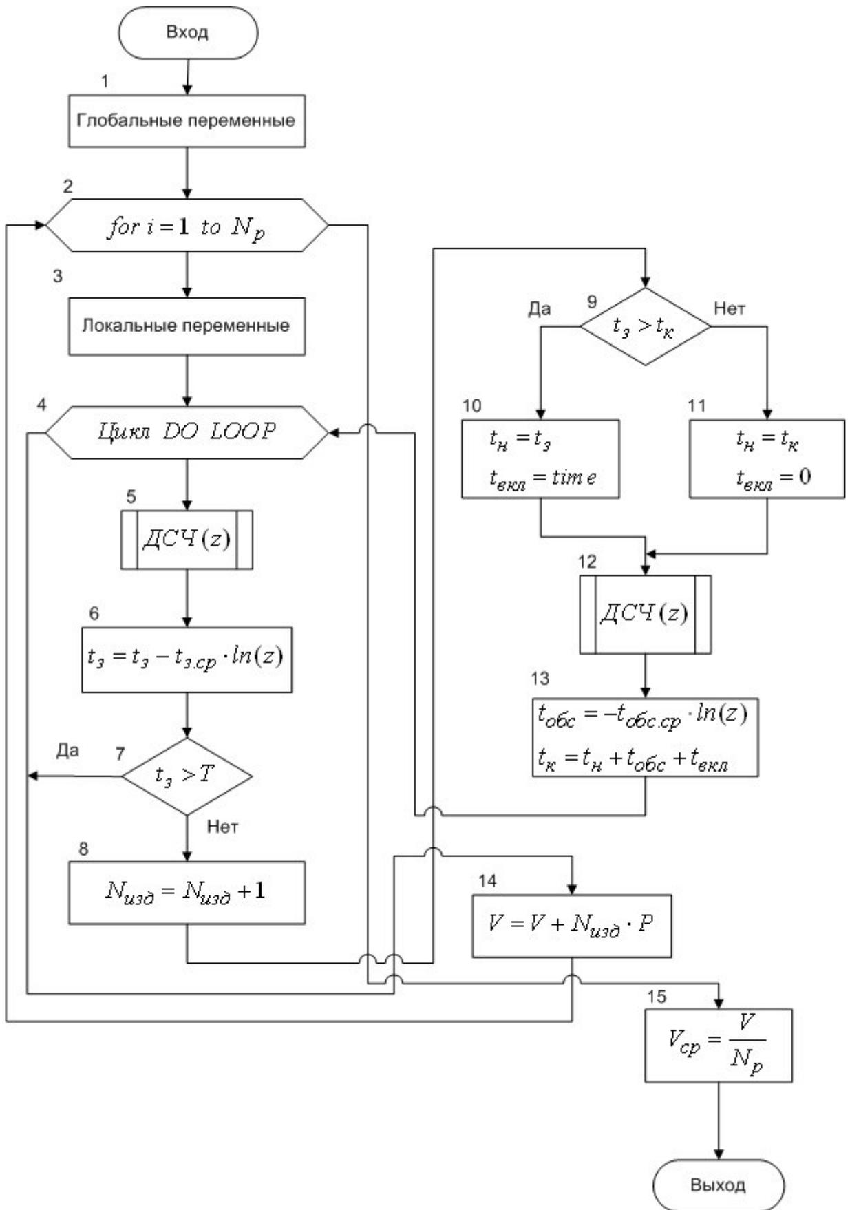
Рис.2.31 – Модификация алгоритма процедуры обслуживания заявок
