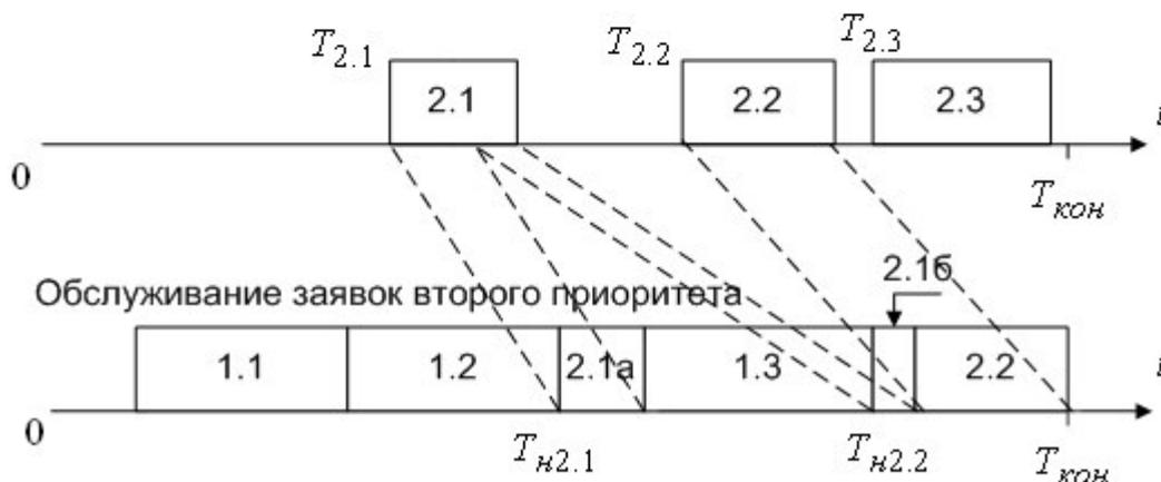
Рис.2.7 – Поэтапная последовательная проводка заявок
