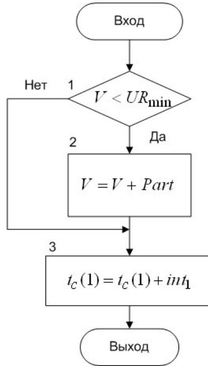
Рис. 3.24 - Алгоритм процедуры моделирования первого события – «Доставка товара»
