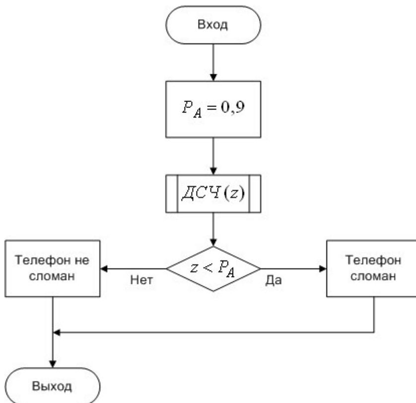
Рис. 1.2 – Алгоритм моделирования события поломки телефона до истечения гарантийного срока
