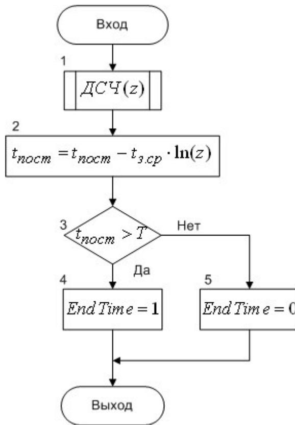
Рис.2.34 - Алгоритм моделирования события «Поступление заказа».
