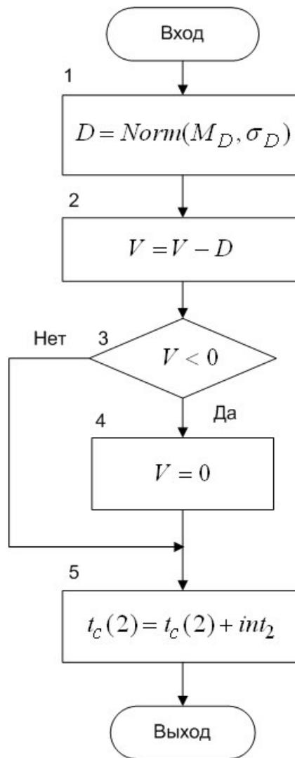
Рис.3.25 - Алгоритм процедуры моделирования второго события – «Покупка товара»
