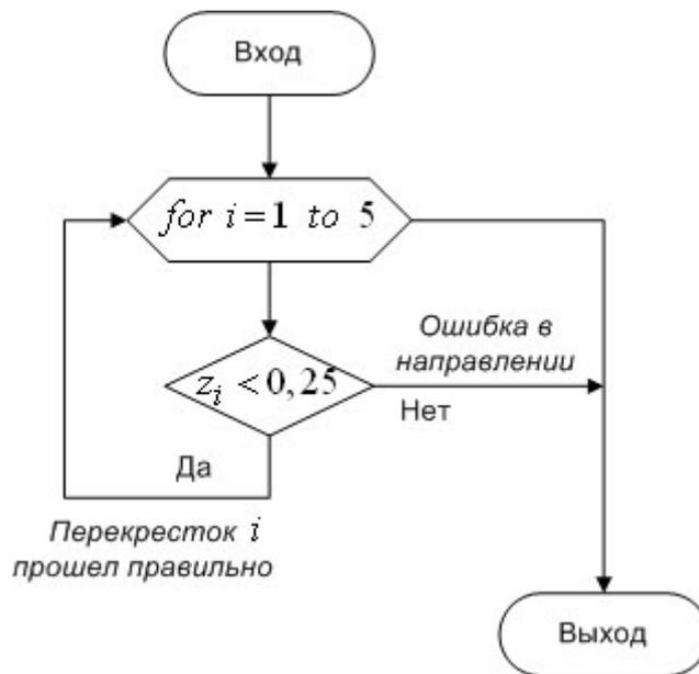
Рис.1.4 – Алгоритм моделирования прохода перекрестка
