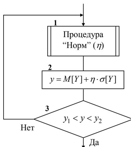
Рис. 1.11 – Алгоритм моделирования случайной величины с усеченным нормальным распределением
