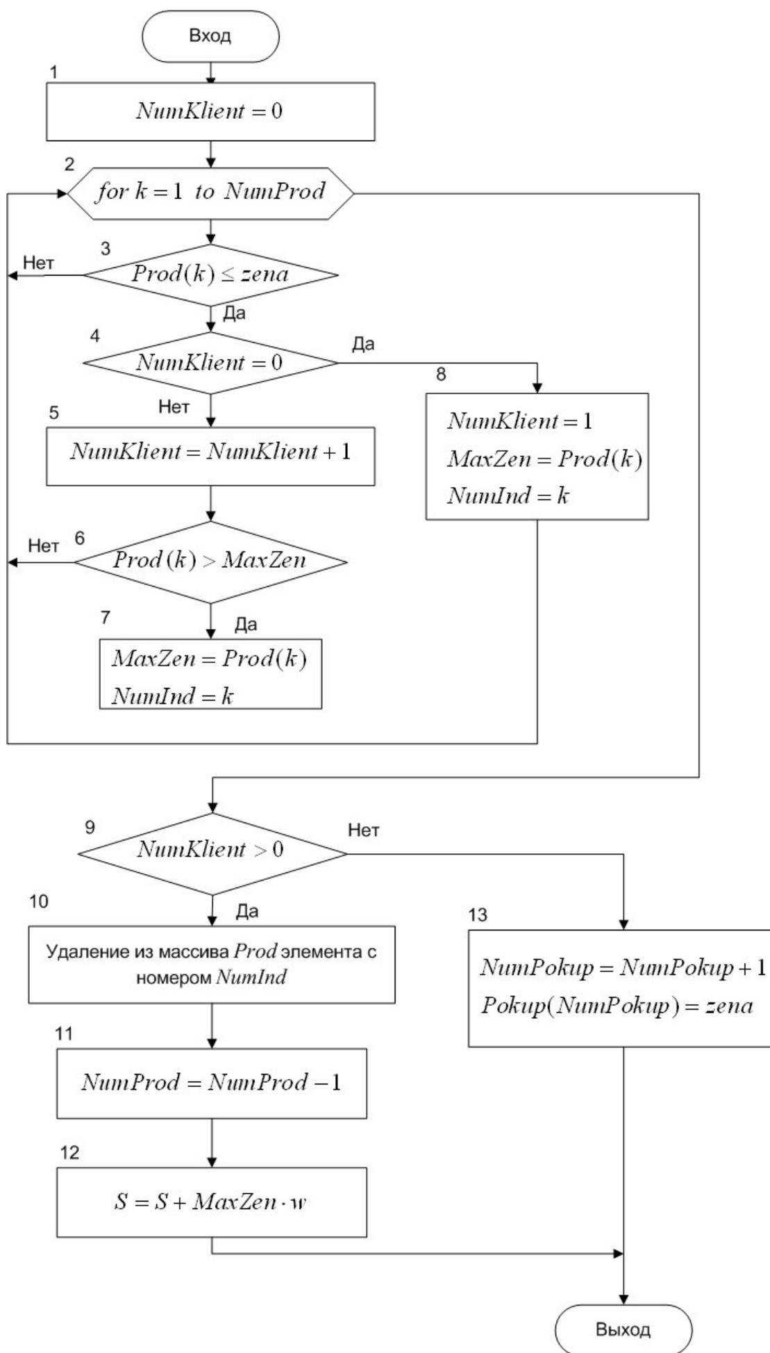
Рис.1.19 – Алгоритм имитации события поступления заявки на покупку
