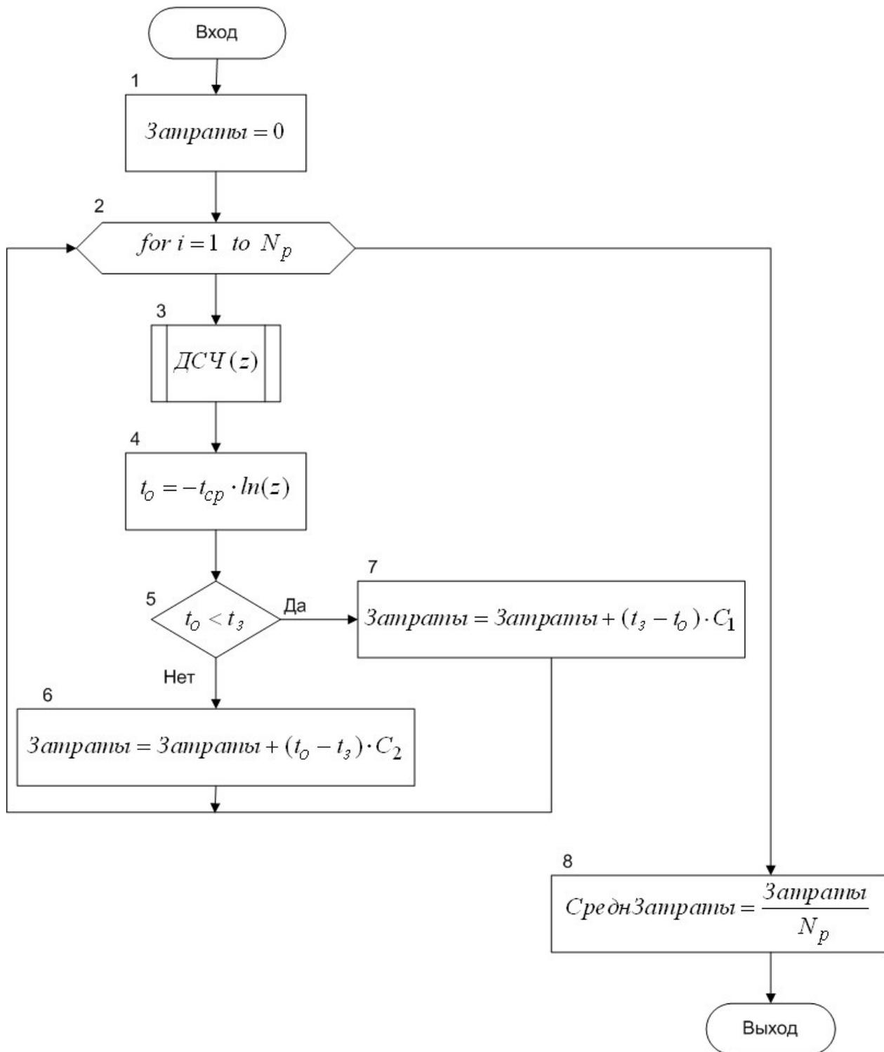
Рис.1.13 – Алгоритм моделирования прибытия человека на платную автостоянку
