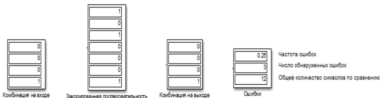
Рис. 3.14. Комбинация на входе, Закодированная последовательность, Комбинация на выходе, Ошибки (вероятность ошибок равна 0,2)
