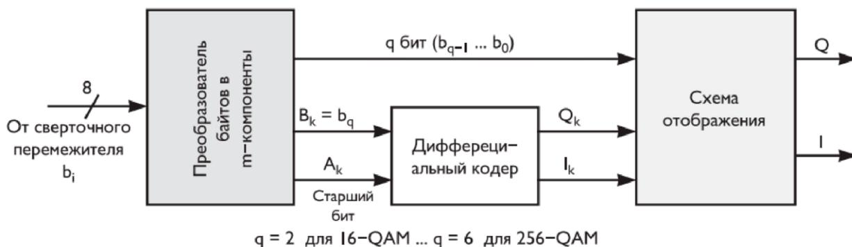
Рис. 5.196. Пример реализации преобразования байта в  $m$ -мерный вектор и дифференциального кодирования двух старших битов
