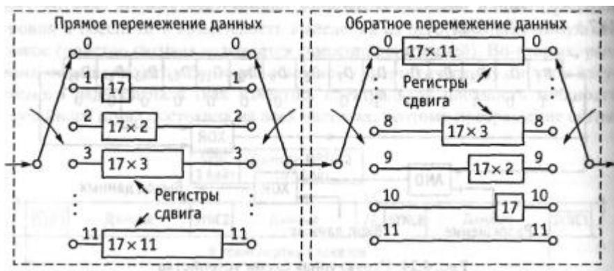
Рис. 5.142. Функциональная схема внутреннего перемежителя данных
