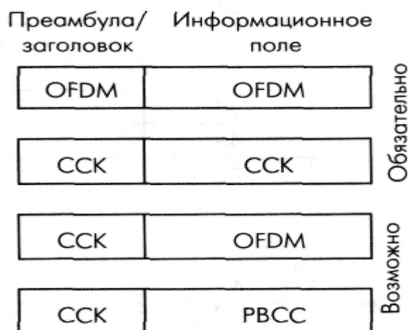
Рис. 5.56. Кадры IEEE 802.11g в различных режимах модуляции
