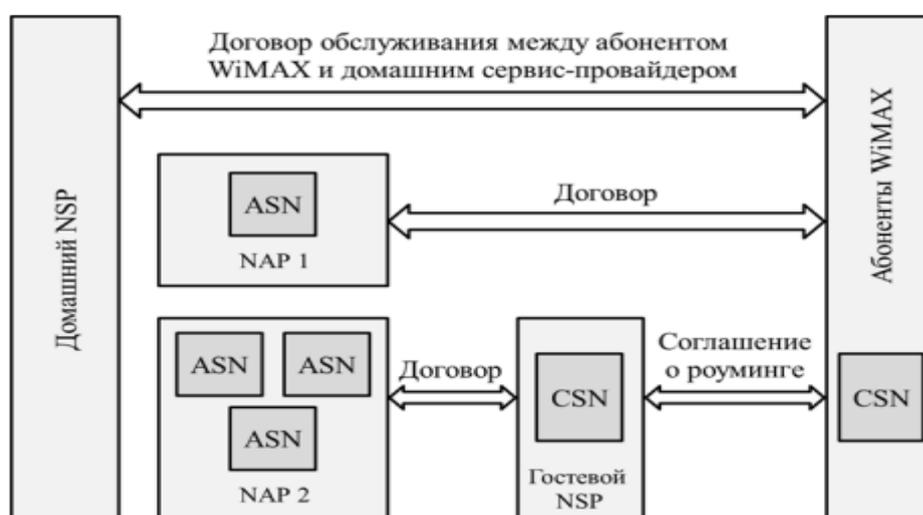
Рис. 5.76. Модель взаимодействия операторов сервисных сетей WiMAX IEEE 802.16, сетей доступа и абонентов
