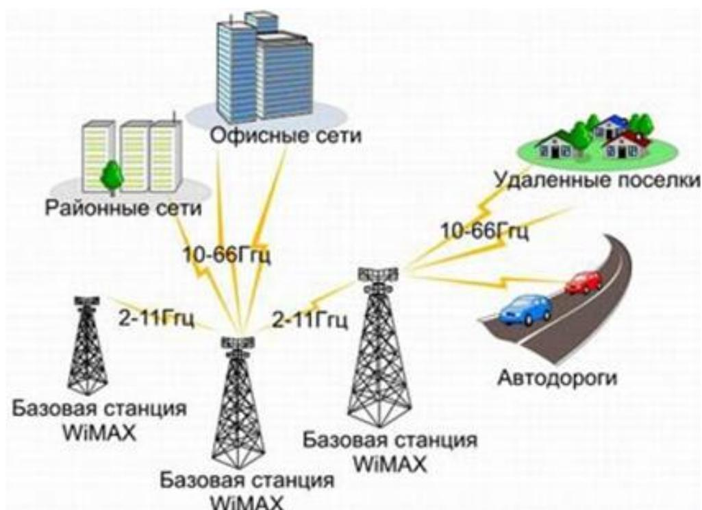
Рис. 5.71. Схематическое изображение сети WiMAX
