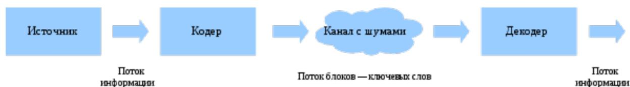
Рис. 3.119. Упрощенная схема передачи информации по каналу связи.
