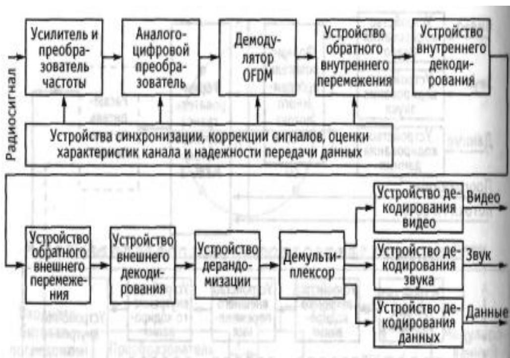
Рис. 5.138. Структурная схема приемника системы DVB-T
