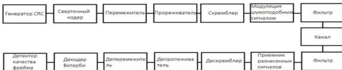
Рис. 5.18. Структурная схема CDMA
