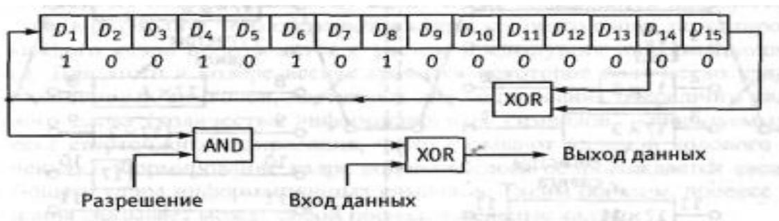
Рис. 5.140. Структурная схема устройства рандомизации данных
