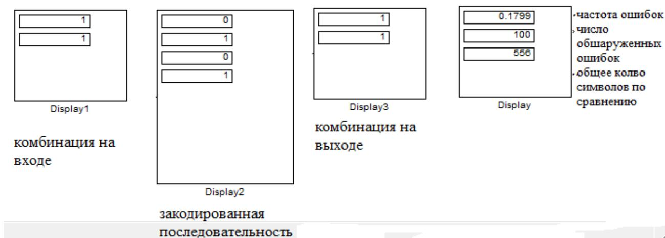
Рис. 3.102. Комбинация на входе, Закодированная последовательность, Комбинация на выходе, Ошибки (вероятность ошибок равна 0,02)
