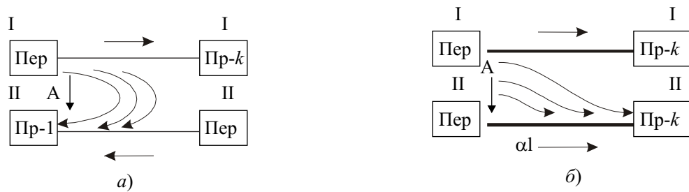
Рис. 3.9 – Возникновение переходных помех: а) на ближнем конце; б) на дальнем конце
