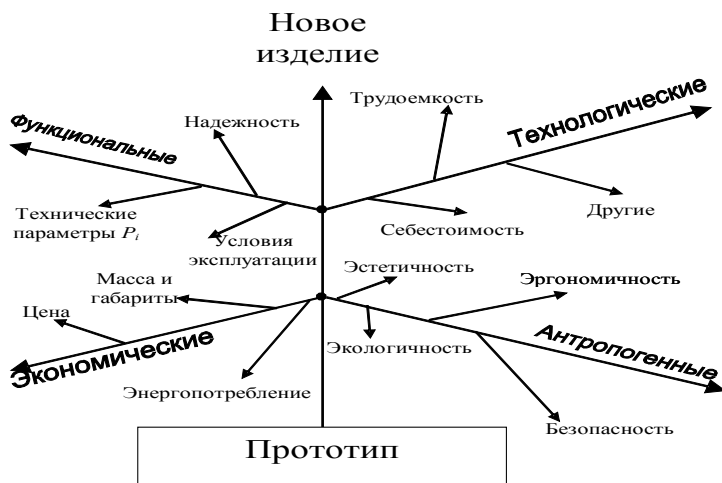
Рисунок 3.2 - Примерный вид дерева целей для радиоэлектронного аппарата
