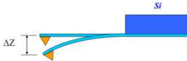
Рис. 5.19. Схематичное изображение зондового датчика АСМ
