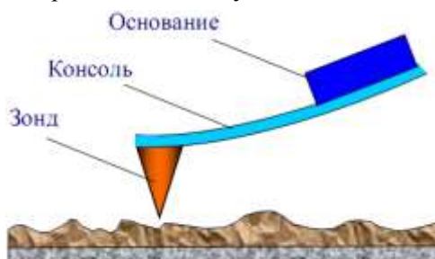
Рис. 5.15. Схематическое изображение зондового датчика АСМ
