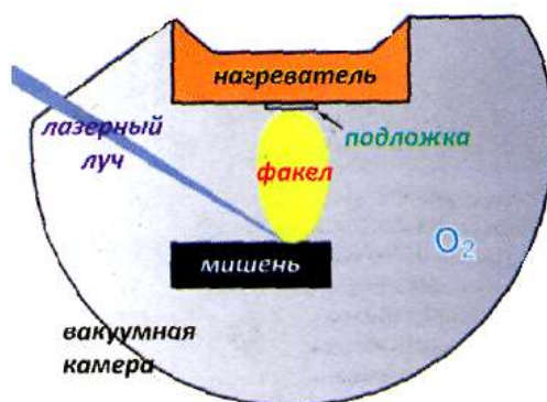
Рис. 1.8. Схема установки для получения пленок импульсным лазерным осаждением
