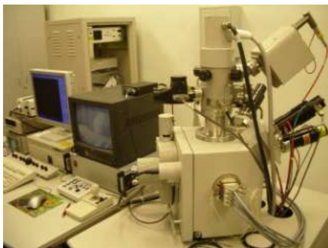
Рис. 6.1. Установка фокусированного ионного пучка Strata FIB 205
