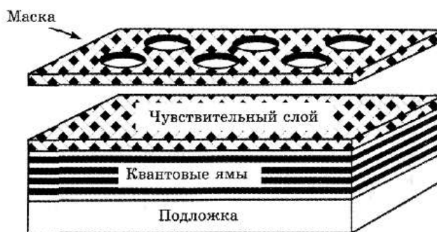
Рис. 1.1. Четырехслойная конструкция из квантовых ям на подложке, покрытой чувствительным слоем. Сверху показана маска для облучения при литографии
