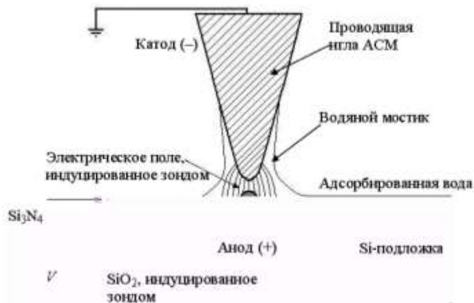
Рис. 5.38. Схематическое представление процесса локального окисления нитрида кремния
