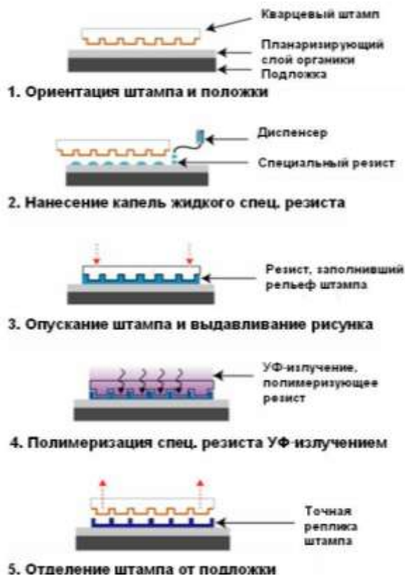
Рис. 4.1. Типовая последовательность технологических операций, выполняемых при литографии методом импринтинга
