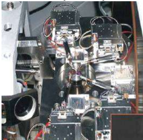
Рис. 6.23. Система микрозондов интегрированная в камеру [15]
