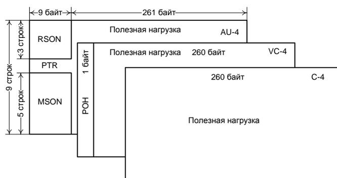
Рис. 1.2 – Структура модуля STM-1
