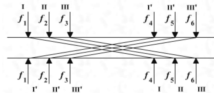
Рис. 1.11 - План с разнесенными частотами приема и передачи
