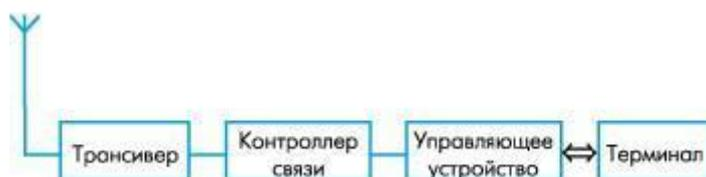
Рис. 8.9. Структура устройства Bluetooth
