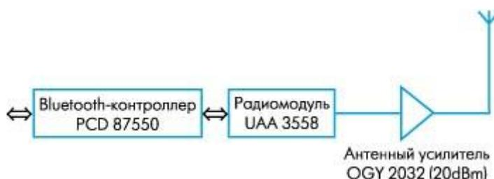
Рис. 8.11. Структура устройства Bluetooth с PCD 87550
