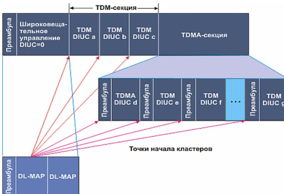
Рис. 9.16. Структура субкадра нисходящего канала для FDD
