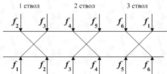
Рис. 1.12 – План с чередованием частот приема и передачи
