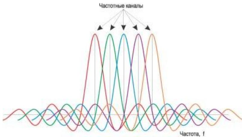
Рис. 9.2. Пример перекрывающихся частотных каналов с ортогональными несущими
