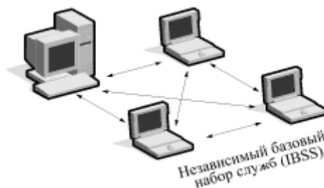
Рис. 7.4 Архитектура сети "Ad-hoc"
