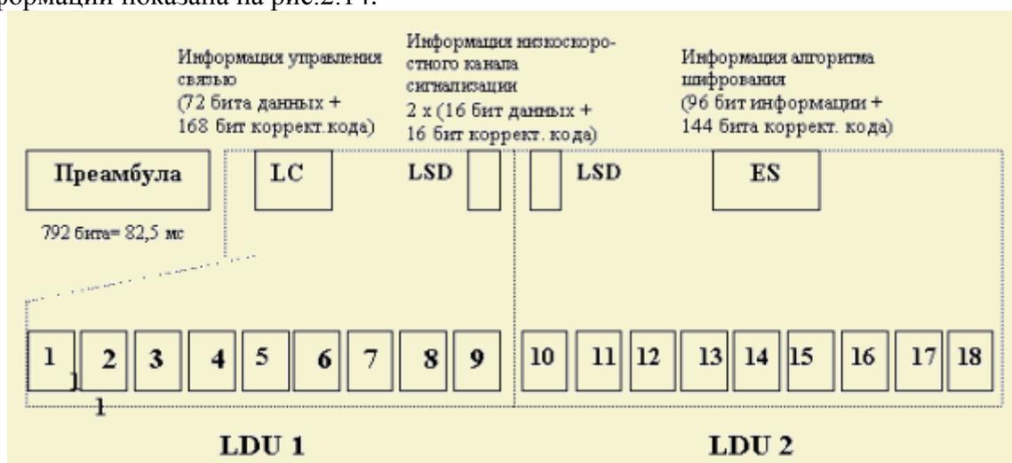
Рис. 2.14. Структура речевого суперкадра в стандарте APCO 25
