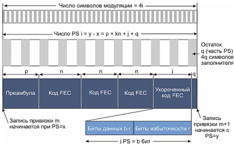
Рис. 9.5. Схема привязки DL-MAP, использующая укороченные блоки FEC - вариант TDMA
