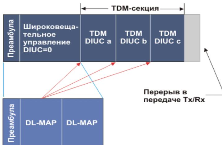
Рис. 9.15. Структура субкадра нисходящего канала для TDD
