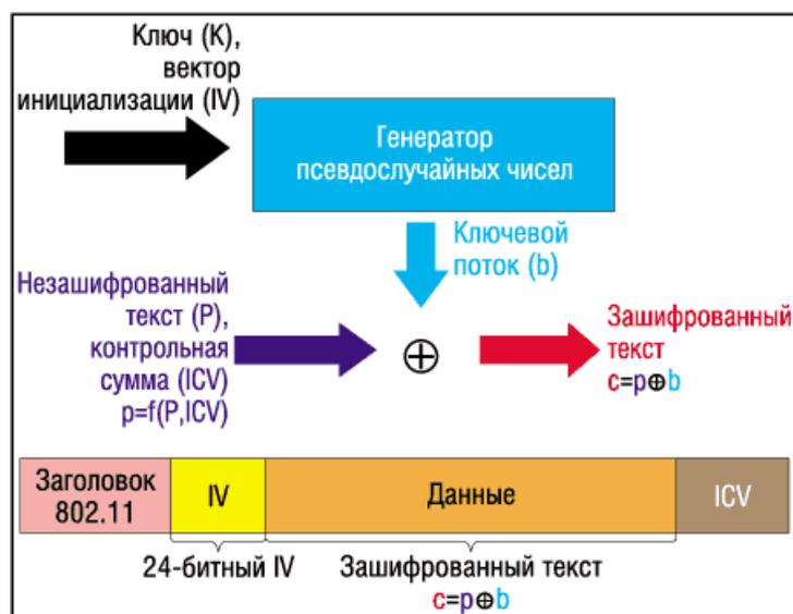
Рис. 7.8. Схема работы шифрования по протоколу WEP
