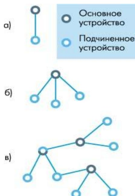
Рис. 8.2. Пикосеть с одним подчиненным устройством (а) ,несколькими (б) и распределенная сеть (в)
