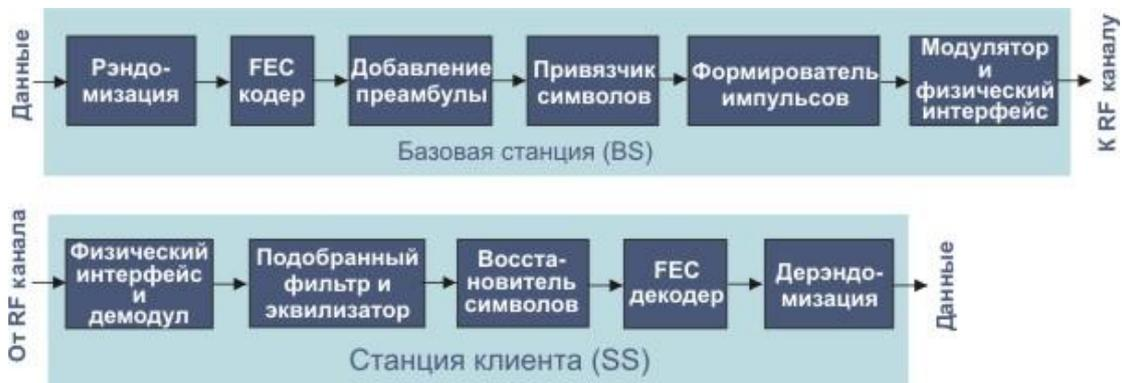
Рис. 9.7. Блок-схема подуровня PMD нисходящего канала
