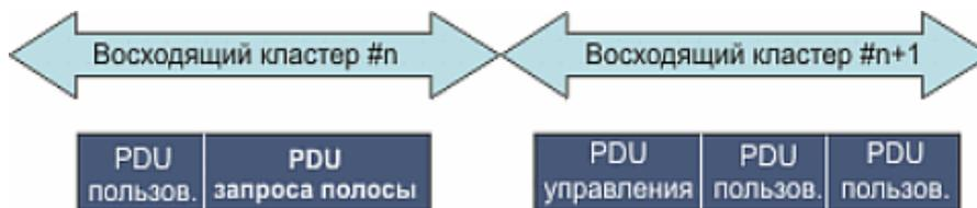
Рис. 9.8. Объединение MAC PDU (каждое из полей имеет свой уникальный CID)
