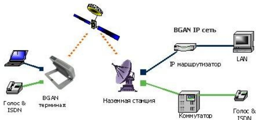
Рис.6.3. Структурная схема сети Inmarsat BGAN
