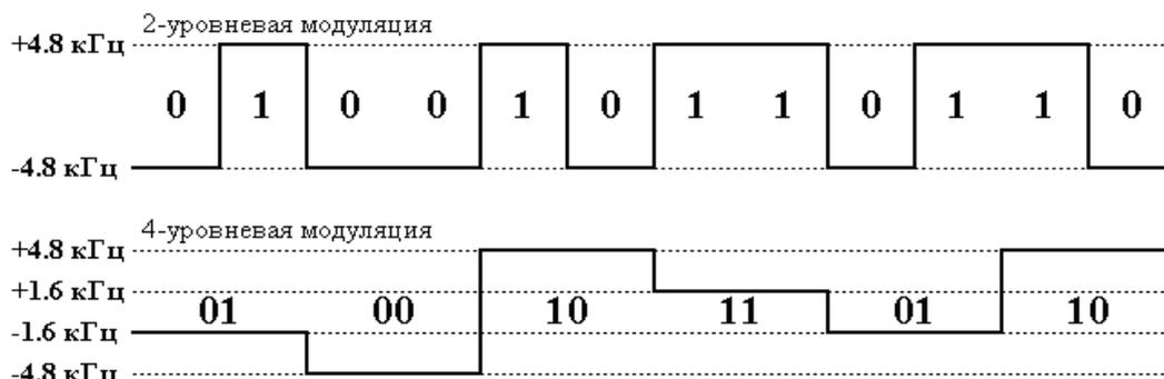
Рис. 5.3. Значения девиации при частотной модуляции
