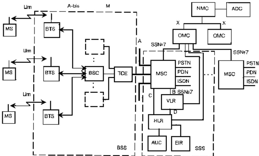
Рис. 3.1. Функциональное построение и интерфейсы стандарта GSM.
