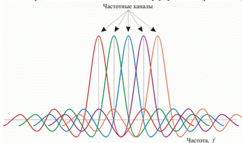
Рисунок 4.17. Пример перекрывающихся частотных каналов с ортогональными несущими
