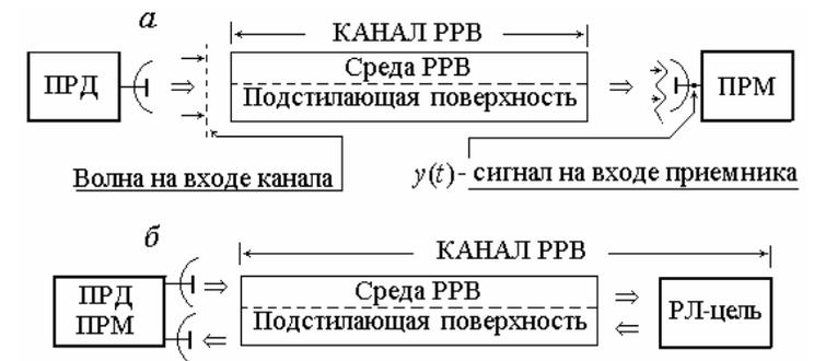
Рис. 2.1. Структура типичных радиоканалов: для РТС передачи информации (а); для измерительных РТС (б). ПРД — передатчик; ПРМ — приемник
