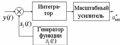
Рис. 4.6. Структура оптимального измерителя амплитуды полностью известного радиоимпульса
