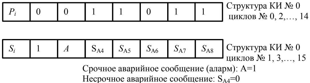
Рис. 2.6. Формат нулевых канальных интервалов чётных и нечётных циклов сверхцикла
