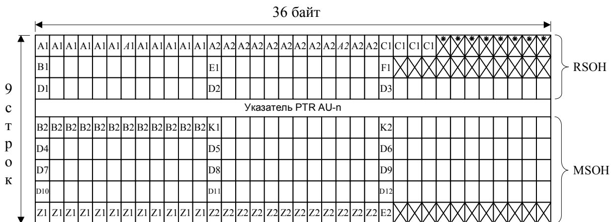
Рис. 3.19. Структура заголовка фрейма STM-N:
