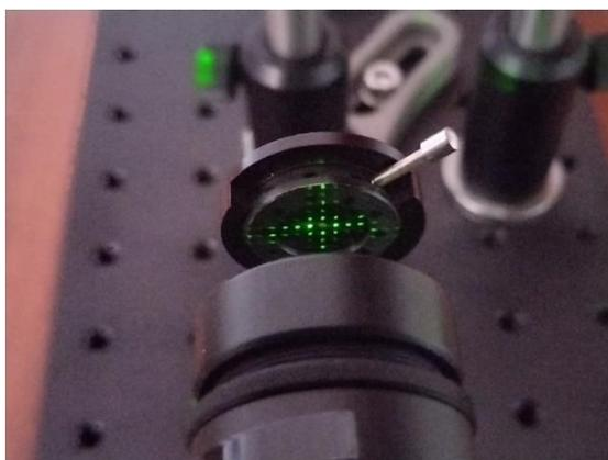
Рисунок 4.5 – Фильтрация центрального максимума ирисовой диафрагмой
