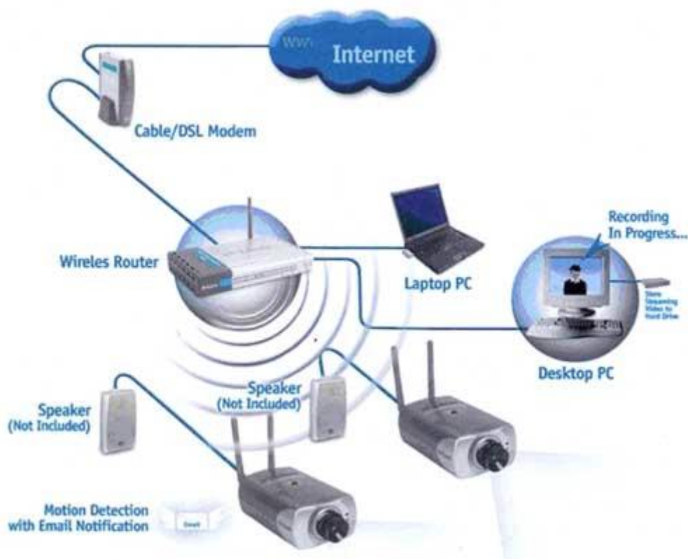
Рис. 2.3.1. Схема системы видеонаблюдения, с применением Wi-Fi
