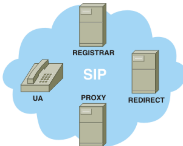
Рис. 3. Архитектура сети на базе протокола SIP
