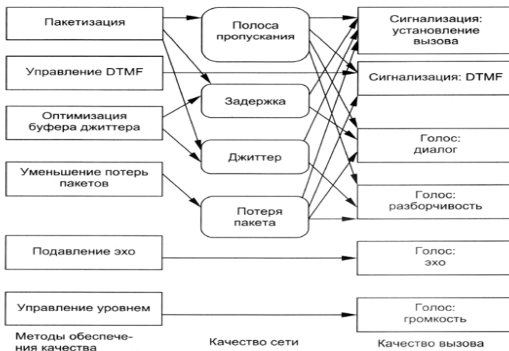
Рис. 5. Схема обеспечения качества IP-телефонии
