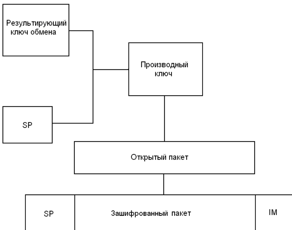
Рис. 23. Шифрование IP-пакета на сетевом уровне.
