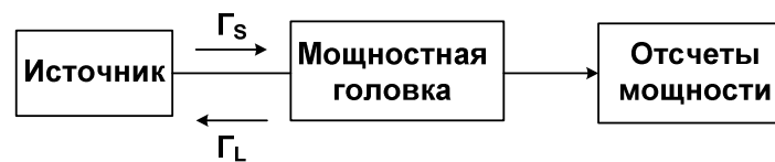
Схематичное представление процесса измерения мощности
