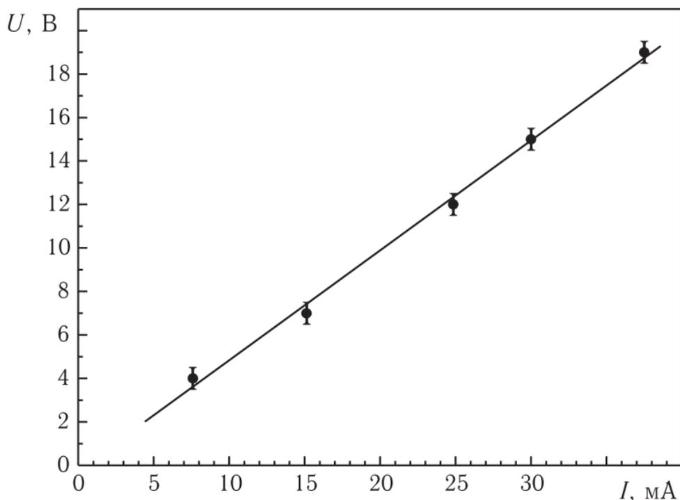
Рисунок 7.2 – Связь между током  $I$  и напряжением  $U$  для постоянного сопротивления
