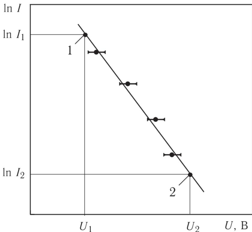
Рисунок 7.3 – Зависимость  $\ln I$  от величины задерживающего напряжения  $U$
