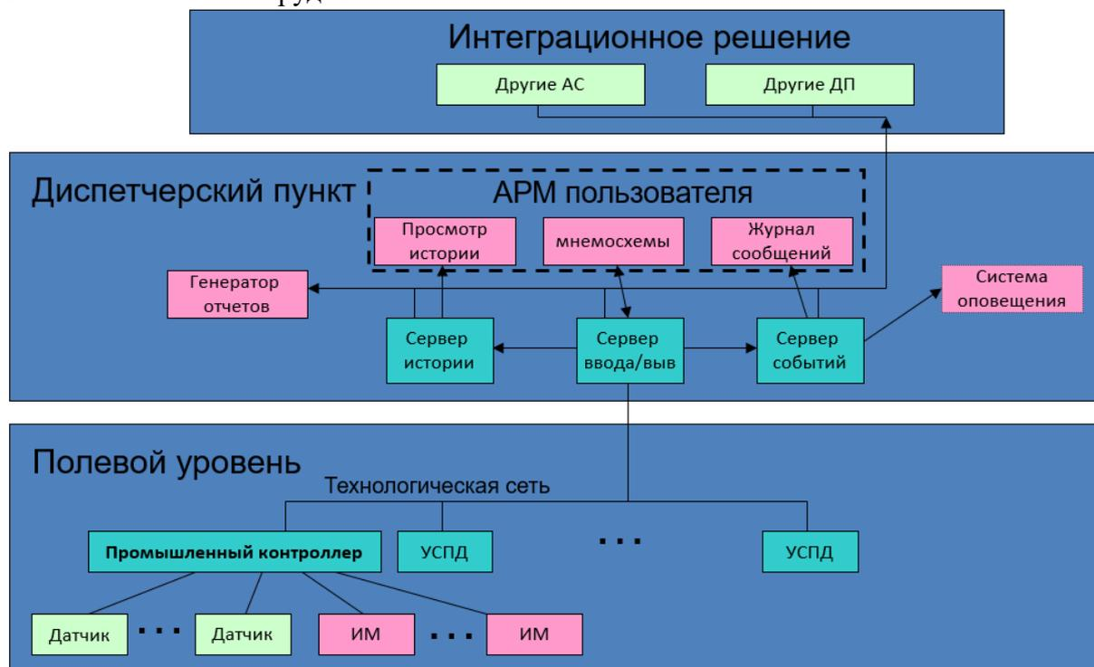
Рисунок В.1 – Общая схема проекта автоматизации технологических процессов
