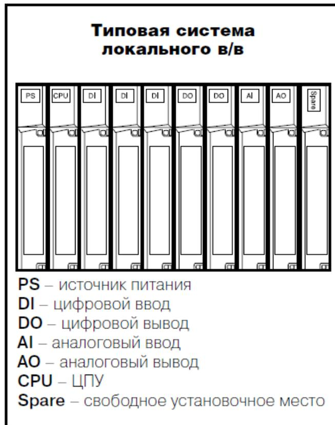
Рисунок 1.8 – Модульный промышленный контроллер
