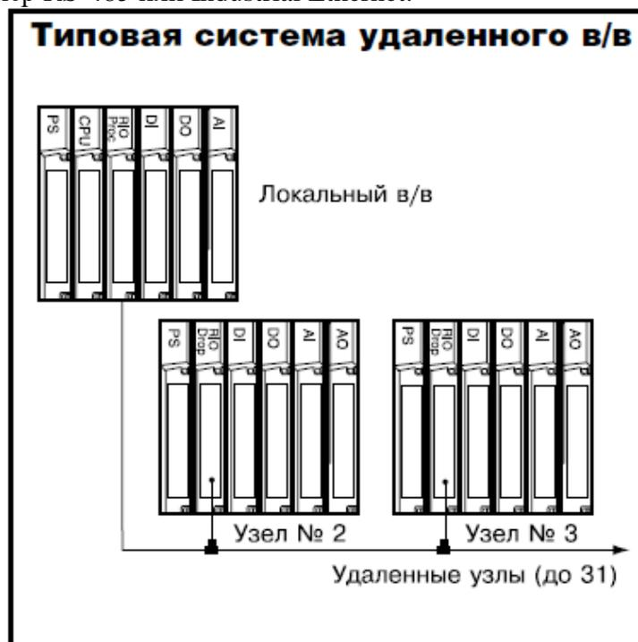
Рисунок 1.9 – Промышленный контроллер с выносными модулями
