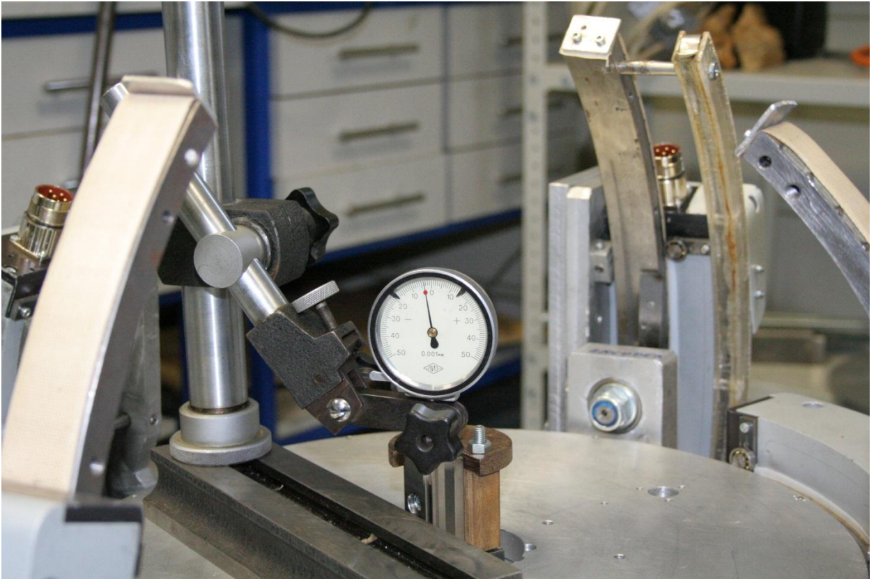
Рис. 127. Четырех координатный манипулятор с установленными индикаторными головками
